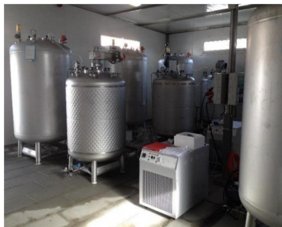
Figura 5: Fermentadores para crescimento de microalgas. (Fonte:AlgaEurope)
