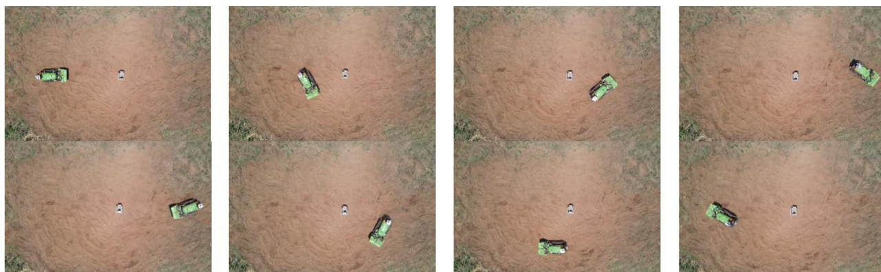
Figura 136 - Fotos do teste prático do controlador Non-Linear com o algoritmo A* para desvio de obstáculos.
