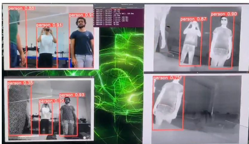
Figura 36 - Realsense e FLIR com algoritmo do YOLO.
