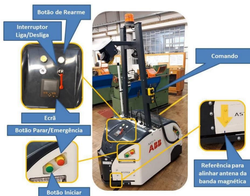
Figura 1 - Tribot 5000 e seus pontos importantes para uma primeira utilização.
