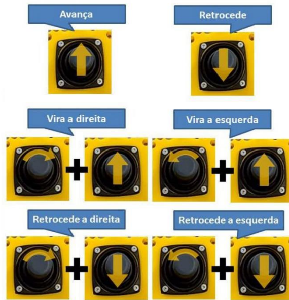
Figura 9 - Operação manual: para executar a movimentação do AGV de forma manual, executar as operações mencionadas, o manipulô pode ser inclinado para frente, para trás e rodar; essas ações e suas combinações fazem com que o AGV avance, retroceda ou vire.
