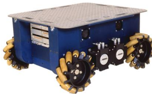
Figura 2.5 - 1985: Uranus (Primeiro AGV com Rodas Mecanum) [11].
