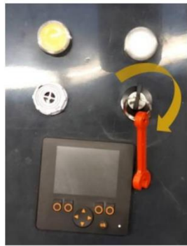
Figura 2 – Iniciar: rodar a chave para direita por 2 segundos
