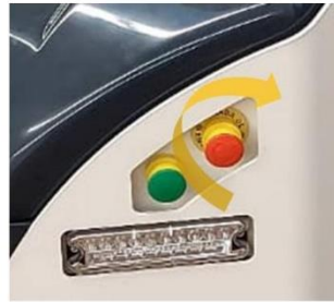
Figura 7 - Destruvar: rodar o Botão Parar/Emergência no sentido da seta indicada no botão
