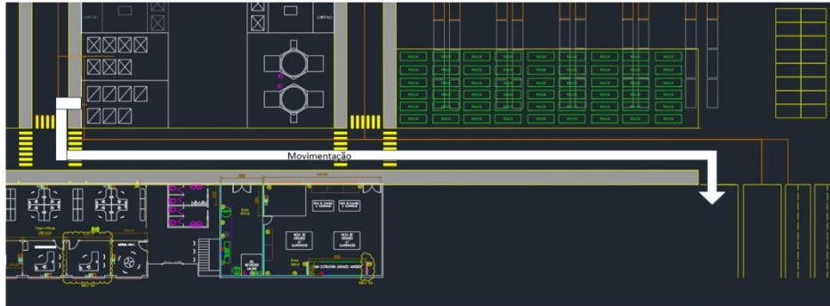
Figura 8.4 - - Movimentação do AGV entre os setores de Montagem de Cabines/Montagem de Acessórios e Expedição
