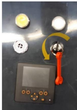
Figura 10 - Desligar: rodar a chave para esquerda por 2 segundos
