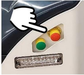
Figura 6 - Parar: carregar no Botão Parar/Emergência, há 4 botões no AGV
