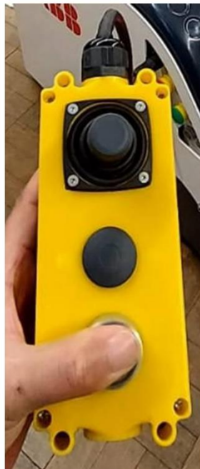
Figura 8 - Operação manual: para executar a movimentação do AGV, o Botão Homem Morto deve estar sempre carregado.
