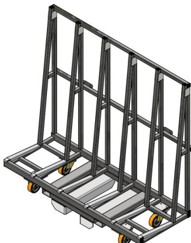
Figura 3.6 - Rack de Vidro (projeto não definitivo).
