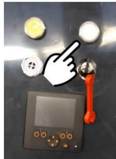
Figura 4 - Rearmar: carregar no Botão de Rearme.
