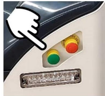
Figura 5 - Iniciar operação: carregar no Botão Iniciar, há 4 botões no AGV
