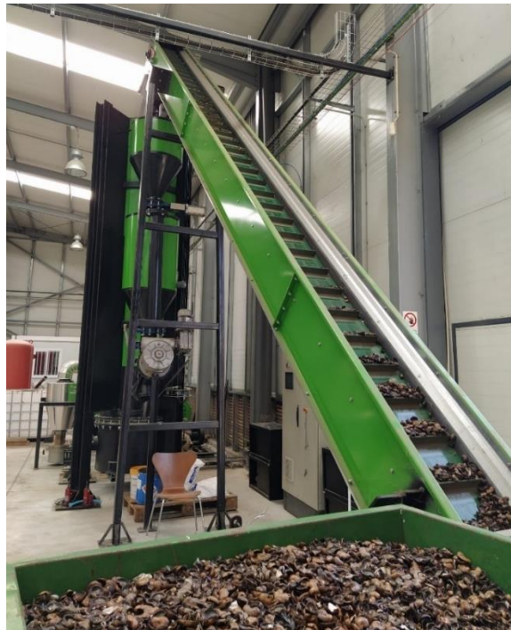
Figura 5. Esteira rolante com os resíduos a serem inseridos no reator.
