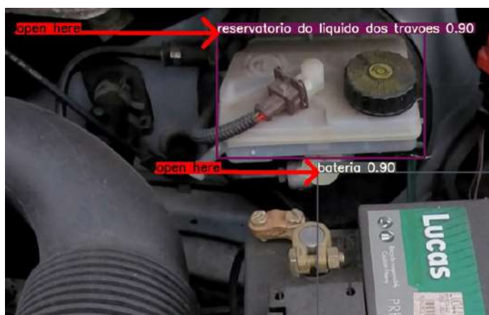
Figura 5.7: Exemplo de deteção numa imagem de teste, onde é identificado o reservatório do líquido dos travões e a bateria.
