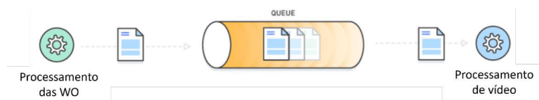
Figura 6 - Esquema de comunicação através de message queue . O servidor é responsável pelo processamento da ordem de trabalho, recebe e envia a mensagem ao detetor que vai processar o vídeo de forma a detetar objetos e apresentar a mensagem pretendida em vídeo.
