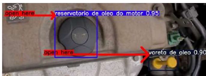
Figura 5.6: Exemplo de deteção numa imagem de teste, onde é identificado o reservatório de óleo do motor e a vareta de óleo.
