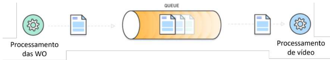
Figura 6.7: Esquema de comunicação através de message queue . O servidor é responsável pelo processamento da ordem de trabalho, recebe e envia a mensagem ao detetor que vai processar o vídeo de forma a detetar objetos e apresentar a mensagem pretendida em vídeo. Baseado em: [8]
