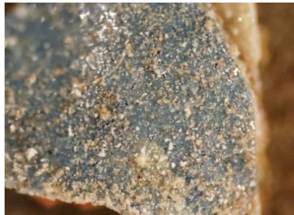
Figura 92 SL7_1, lado da superfície; 40x; Luz refletida CF Vítor Gaspar
