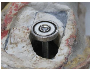
Figura 52 Fixação do parafuso e íman na posição correta
