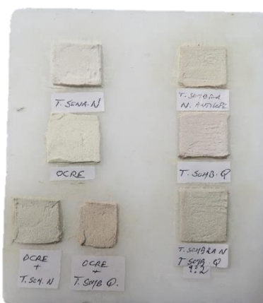
Figura 223 Testes de argamassa de cal aérea e pigmentos minerais
