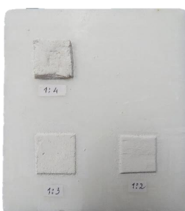
Figura 222 Testes de argamassa de cal com pó de mármore
