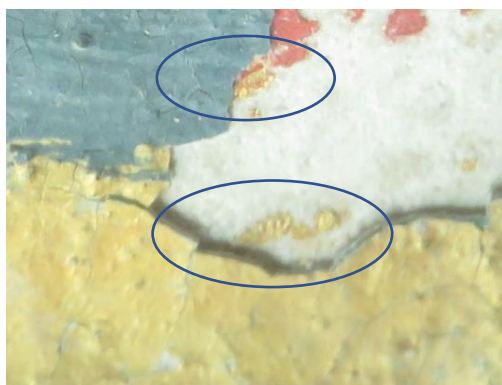
Figura 31 Sob a policromia observa-se folha metálica sobre uma camada vermelha
