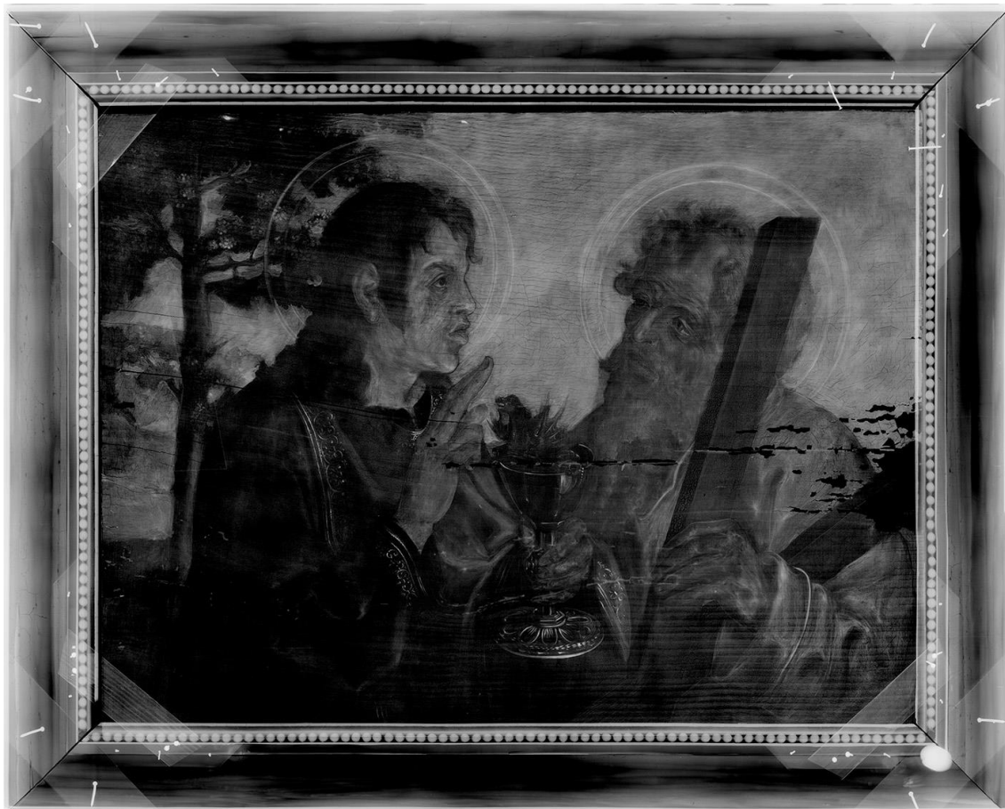
Pintura sobre madeira - “São João Evangelista e Stº André”, Grão Vasco (?), séc. XVI Radiografia de feixe contínuo com a ampola de 160 kV
