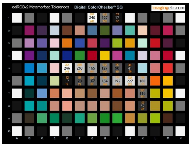
Valores e tolerâncias dos neutros na Metamorfoze e no espaço de cor eciRGBv2 com a mira DCSG
