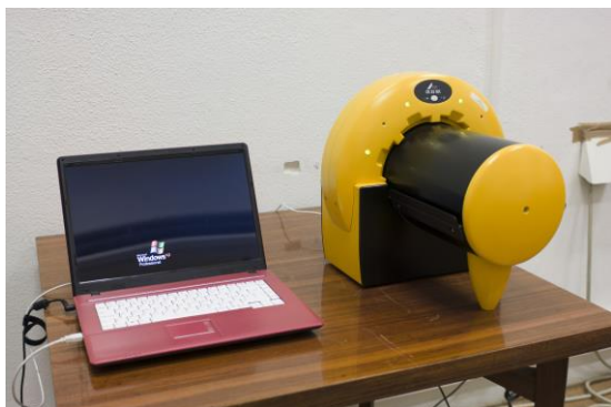
Scanner “Durr NDT – CR_35_SEC” + Computador exclusivo deste sistema
