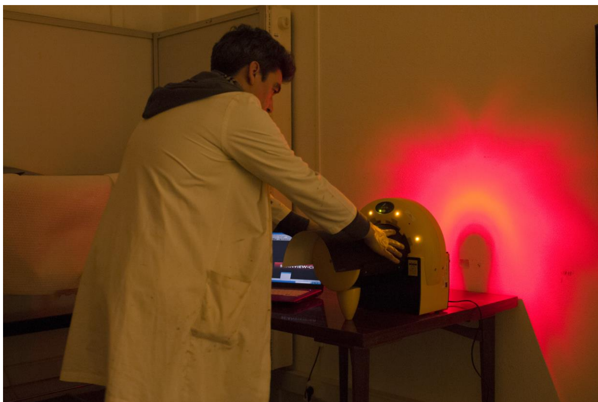
Introdução da chapa radiográfica no scanner para digitalização
