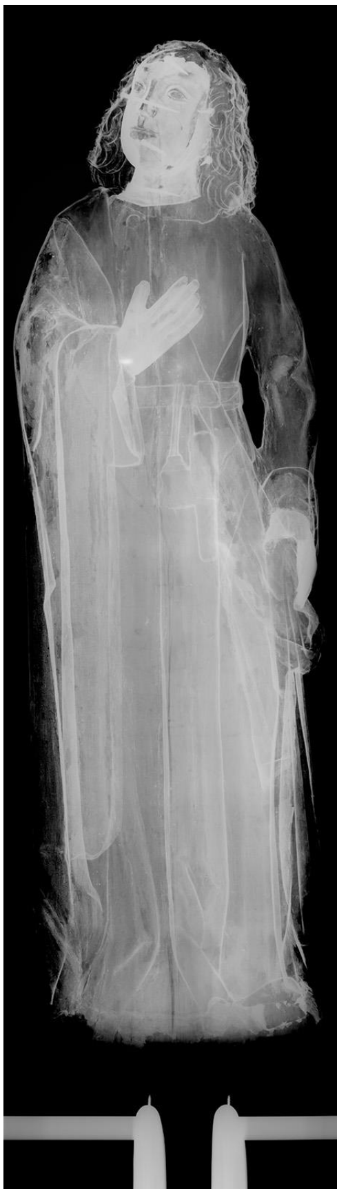
Escultura em madeira policromada - “São João Evangelista”, séc. XVI Radiografia de feixe contínuo com a ampola de 160 kV Frente
