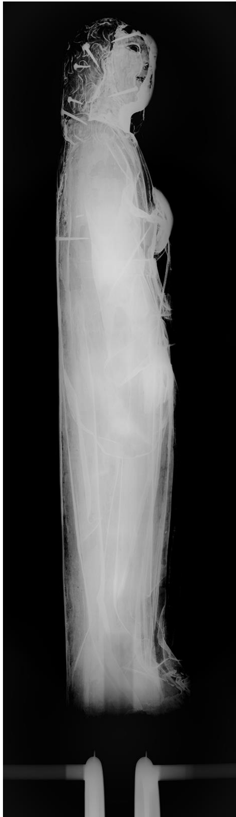
Escultura em madeira policromada - “São João Evangelista”, séc. XVI Radiografia de feixe contínuo com a ampola de 160 kV Lateral a 90°
