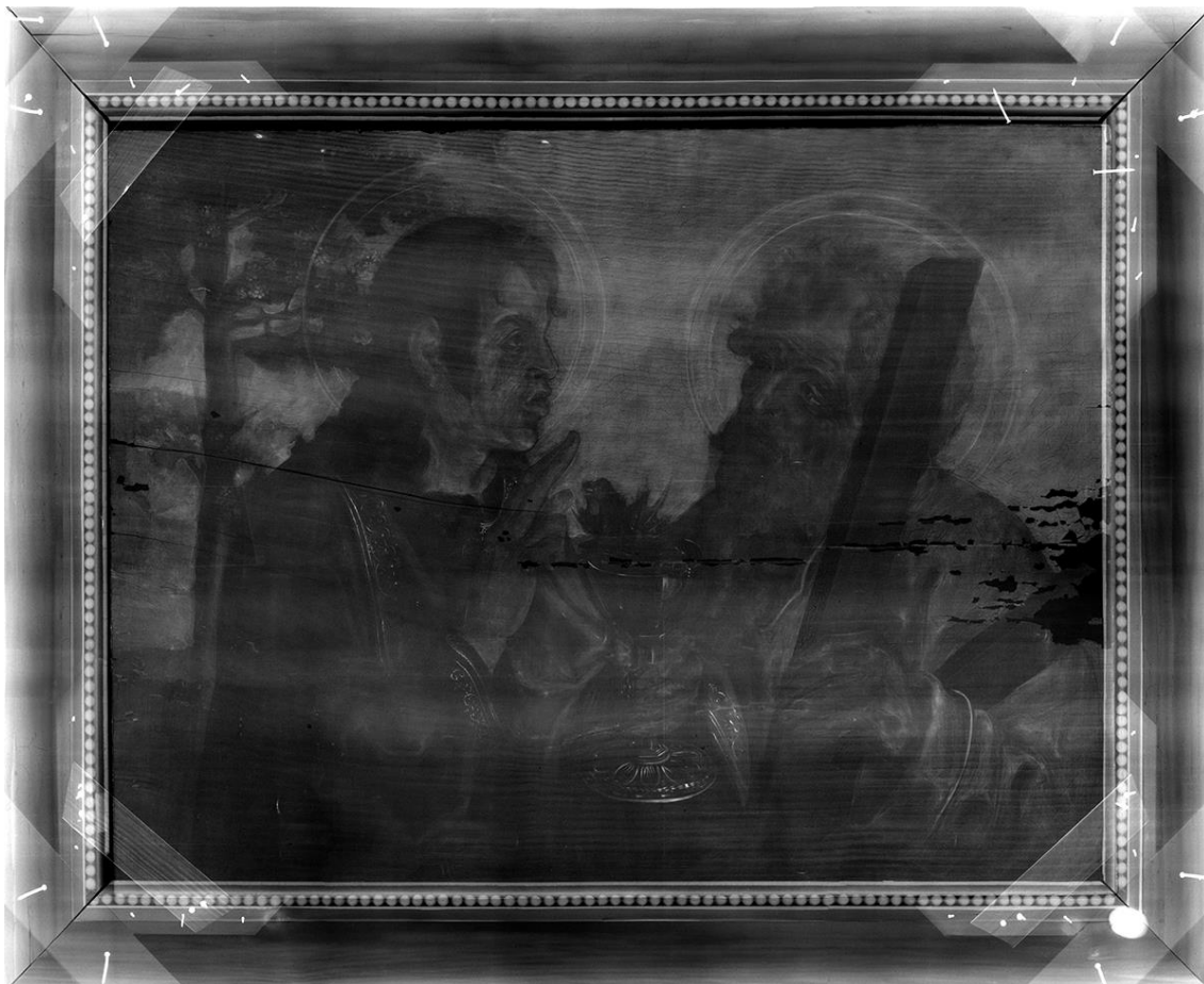
Pintura sobre madeira - “São João Evangelista e Stº André”, Grão Vasco (?), séc. XVI Radiografia de feixe pulsante com a ampola de 150 kVp
