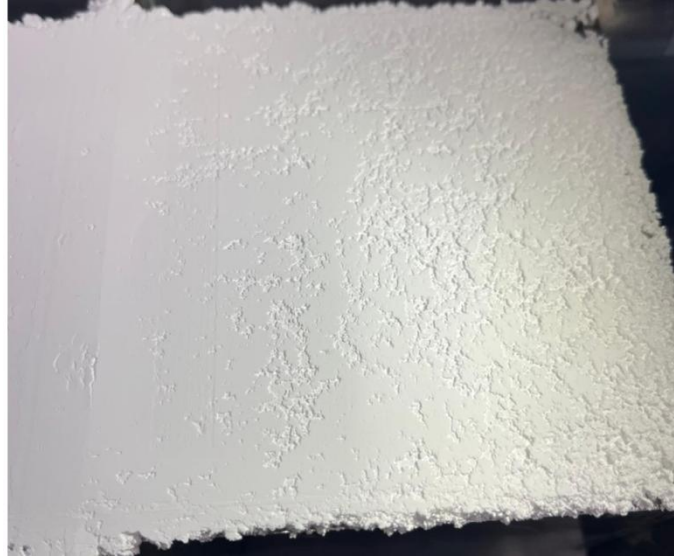
Figura 35 - Imagem da camada de HAp-2 após a impressão
