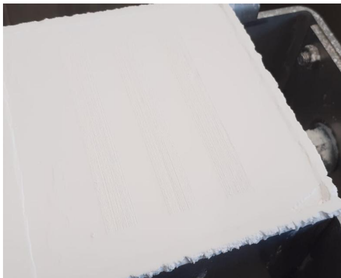
Figura 34 -Imagem da camada de HAp-1 após a impressão
