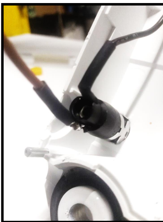
Figura 72: Restabelecimento da ligação elétrica, com o fio da fase a ser novamente soldado ao respetivo terminal de contacto.
