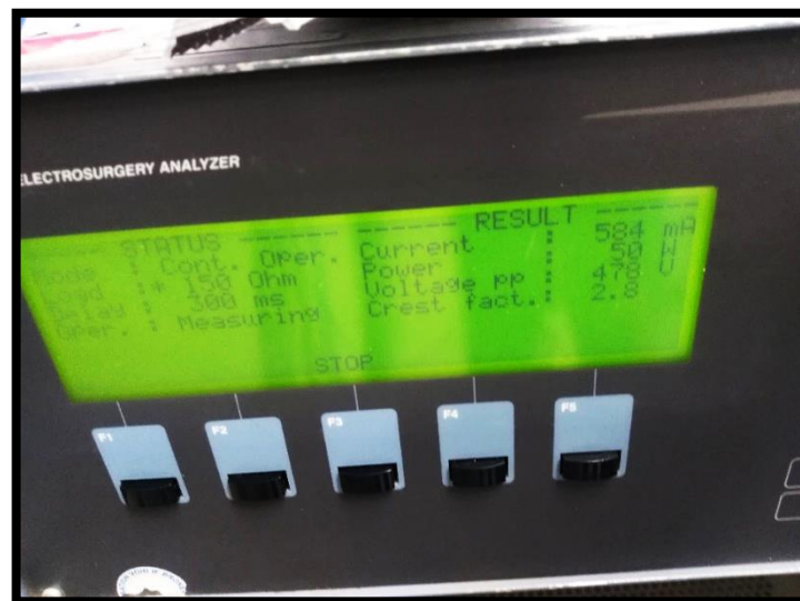
Figura 53: Ajustamento dos parâmetros como modo de aquisição do sinal e resistência no equipamento de teste.
