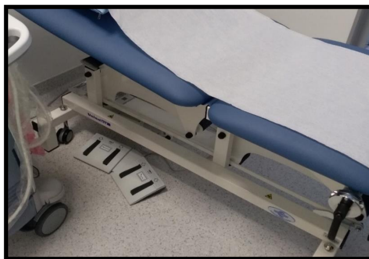
Figura 36: Testado o funcionamento dos controlos do pedal que permitem ajustar as várias posições da marquesa elétrica.
