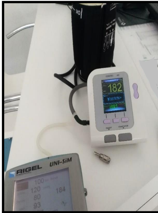
Figura 43: Aquisição e validação dos valores de pressão sistólica e diastólica.
