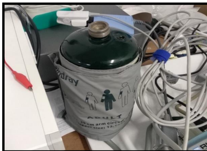
Figura 41: Aquisição e validação dos valores de pressão sistólica e diastólica.
