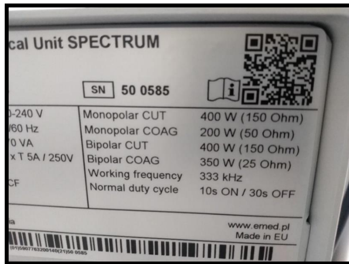
Figura 52: Chapa de características existente em cada equipamento de eletrocirurgia.
