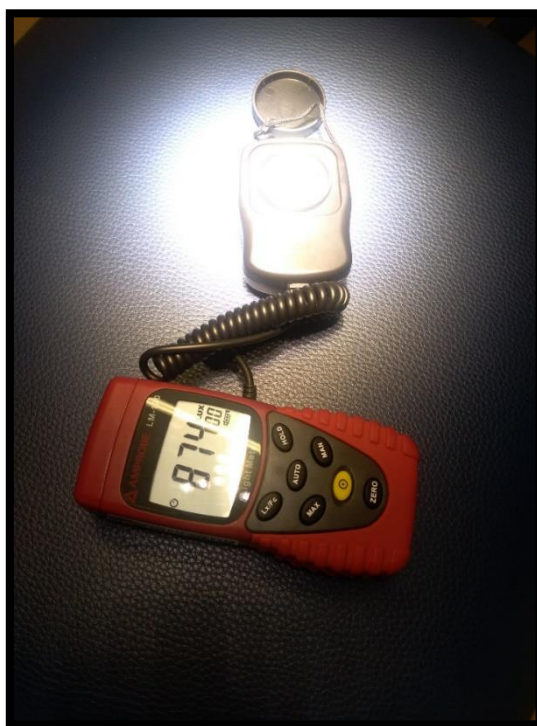
Figura 49: Medição do valor da luminosidade do equipamento através do luxímetro
