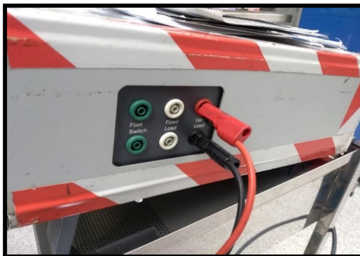
Figura 54: Conjunto de ligações realizadas no equipamento. O cabo vermelho irá permitir criar a ligação do eléctrodo ativo enquanto o cabo preto a ligação do eléctrodo neutro.
