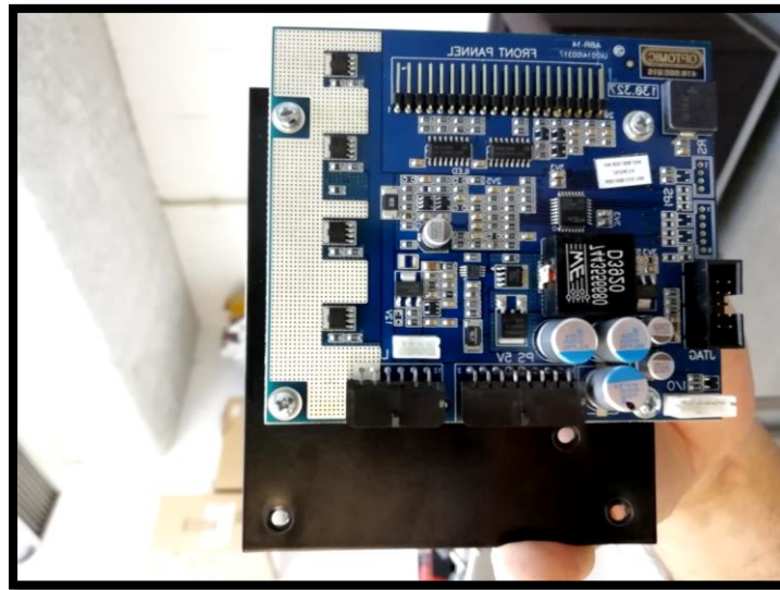
Figura 76: Remoção da placa eletrônica e remoção dos componentes danificados.
