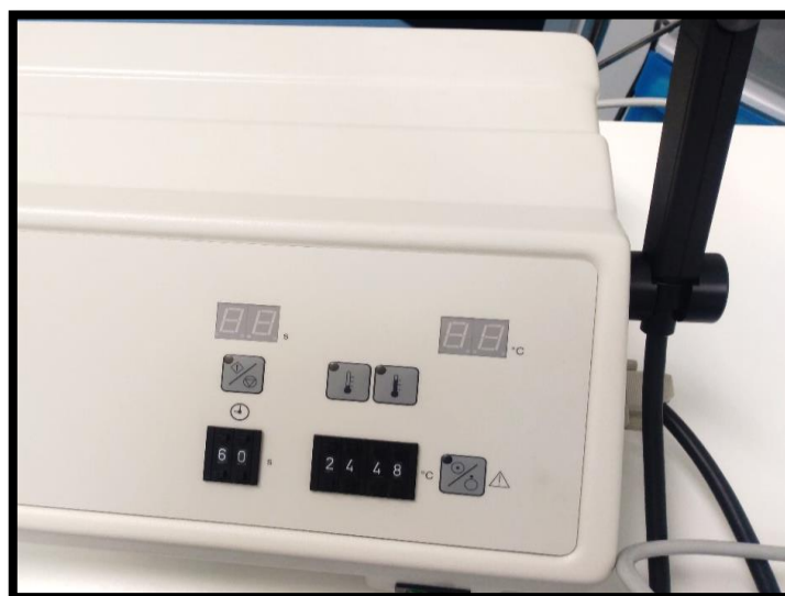
Figura 55: Verificação do estado dos controlos e da ponta de prova do equipamento.
