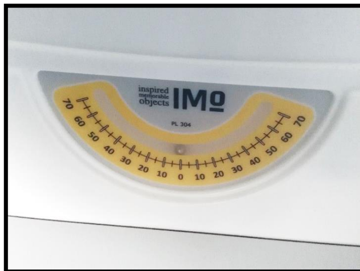
Figura 34: Nível da cama elétrica. Uma das etapas na manutenção preventiva consistiu na verificação do estado de conservação e a presença da esfera que informa a angulação da cama elétrica.
