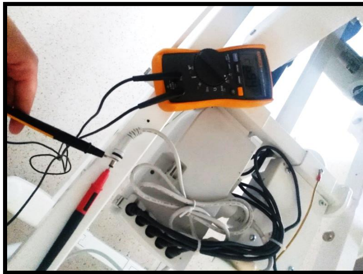
Figura 33: Medição do valor das baterias com o multímetro, em que cada cama é constituída por um conjunto de duas baterias de 12 V cada. As baterias encontram-se funcionais e com autonomia quando o seu valor de tensão é superior a 24 V.
