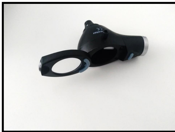
Figura 48: Limpeza da lente pivotável e verificação do funcionamento da lâmpada.
