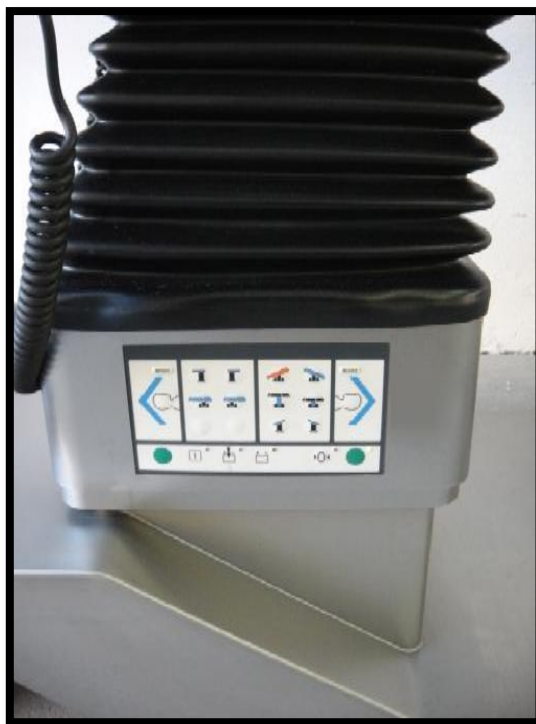
Figura 44: Verificação do estado da coluna e realização de teste e ensaios funcionais através do comando do equipamento e nos controlos incorporados na coluna.
