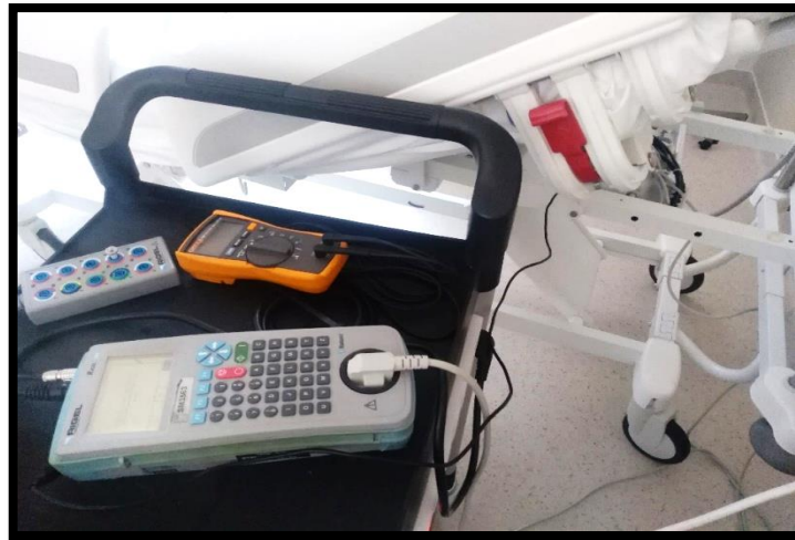
Figura 35: Realização de teste de segurança elétrica.
