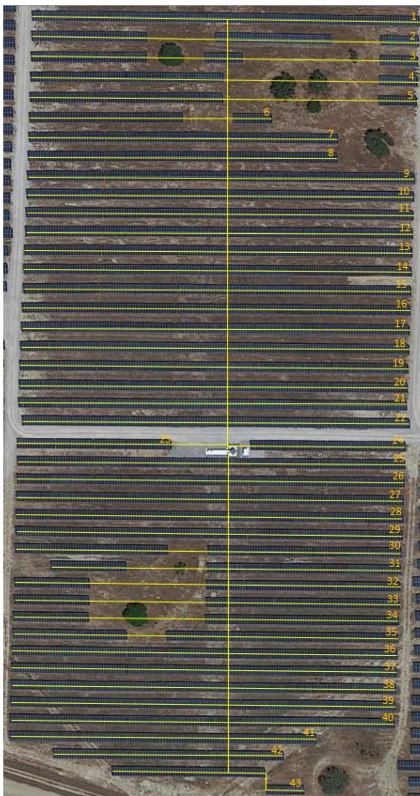
Figura 5.1 - Esquema de ligação dos condutores em CC no parque fotovoltaico Ourika.
