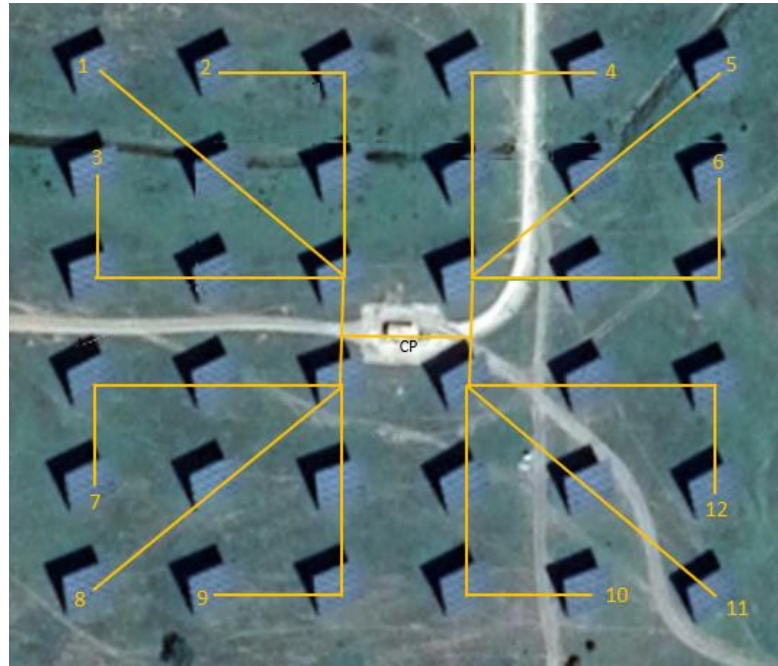
Figura 5.5 - Esquema de ligação dos condutores em CC no parque fotovoltaico CFMoura.
