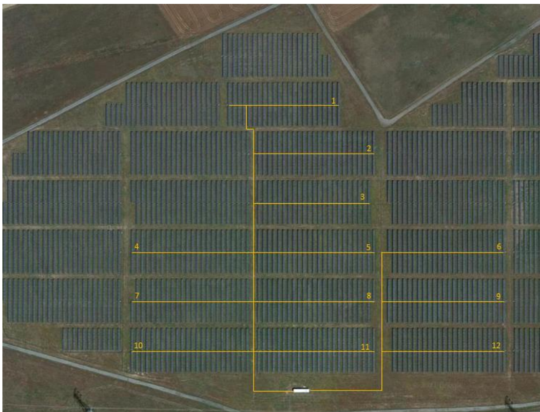
Figura 5.3 - Esquema de ligação dos condutores em CC no parque fotovoltaico Ourika.
