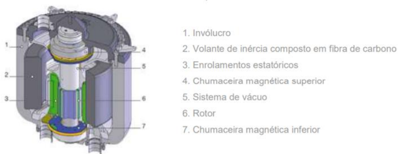
Figura 9.5. Representação em corte de um volante de inércia (Trovão, 2012).
