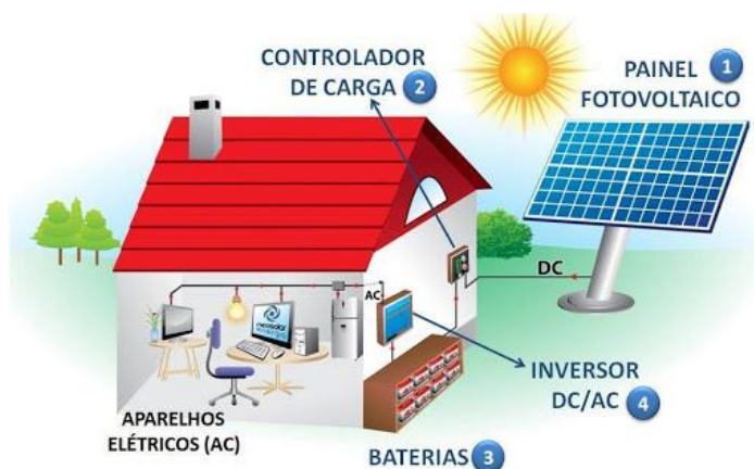
Figura 3.9. Sistema PV isolado com armazenamento (Justo, 2018).
