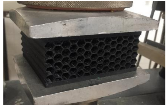
Figura 8. Dissipador com estrutura celular hexagonal (100x100x50).
