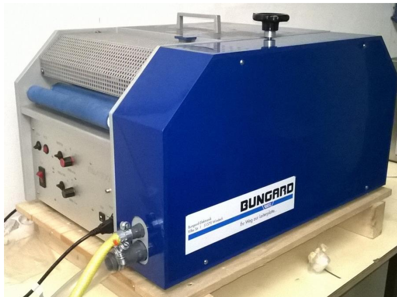
Figura 70 - Máquina de limpeza das PCB's com rolos abrasivos
