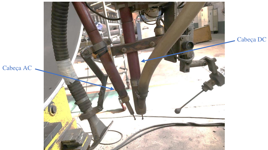
Figura 32 - Dupla “cabeça” das máquinas de soldar do tipo “Cristo”
