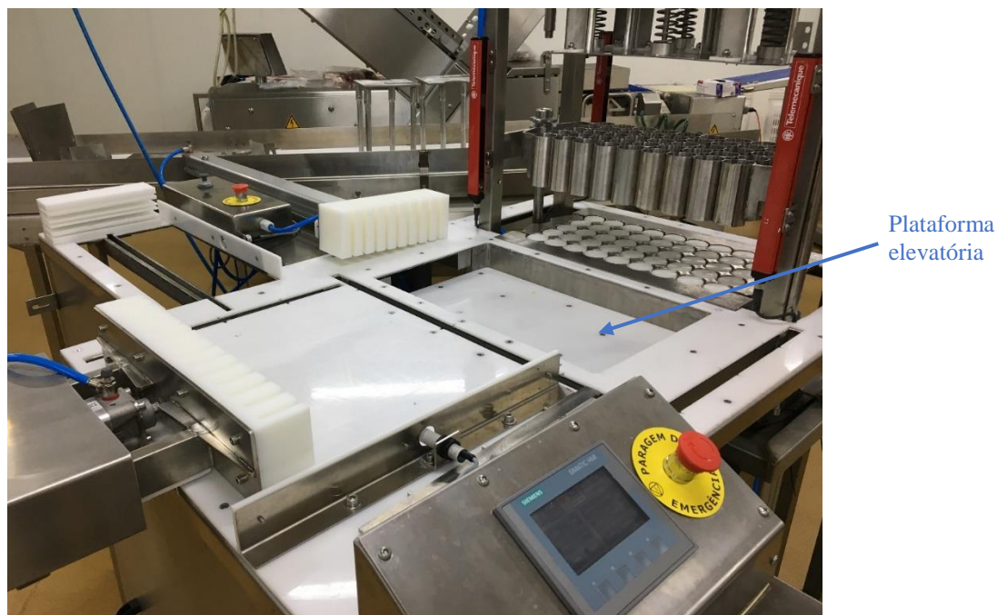
Figura 82 - Máquina de corte de queijo plataforma elevatória
