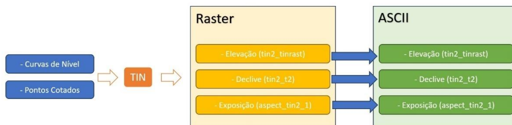
Figura 7 - Esquema do processo de preparação de dados para o FlamMap, relativos à topografia
