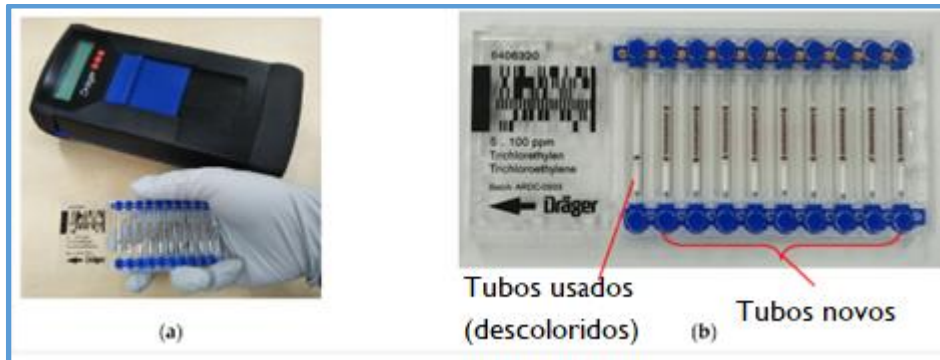
Figura 1 - Imagem do tubo detetor de gás no sistema de chip: (a) detetor de gás (fotómetro e bomba de ar); (b) tubo detetor de gás em chip pequeno (10 tubos no chip) (Fonte: Kawamura et al, 2021)
