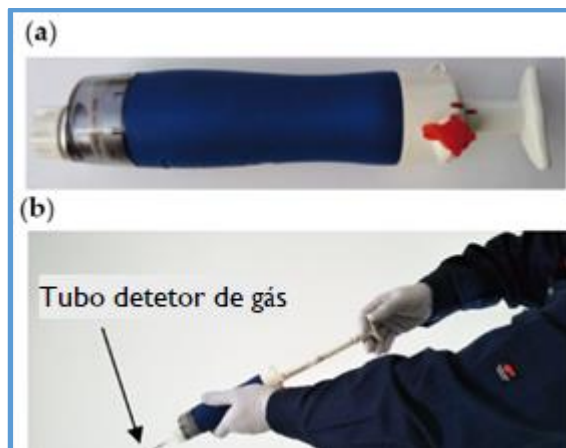
Figura 2 - Bomba e tubo detetor de gás: (a) bomba de aspiração para o tubo detetor de gás; (b) método de amostragem para o tubo detetor de gás (Fonte: Kawamura et al, 2021)
