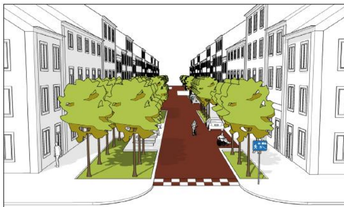
Figura 10 Entrada de uma zona de coexistência, Manual de Zonas Residenciais e de Coexistência [28]
