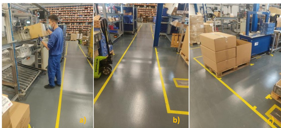
Figura 65 - Estado final das linhas de montagem: a) maior área dedicada; b) corredores largos e desimpedidos; c) espaço disponível para a realização de todas as operações.
