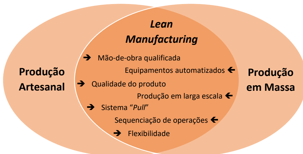
Figura 1 - Combinação da Produção Artesanal e da Produção em Massa: Lean Manufacturing . Adaptado de Womack et al. (1990).
