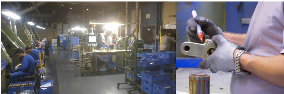
Figura 27 - Zona de polimento, automático e manual (à esquerda); inspeção e marcação de zonas com defeito (à direita).
