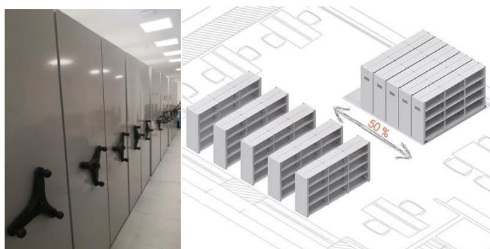
Figura 56 - Esquemática do novo sistema de armazenamento de ferramentas baseado em estantes móveis.
