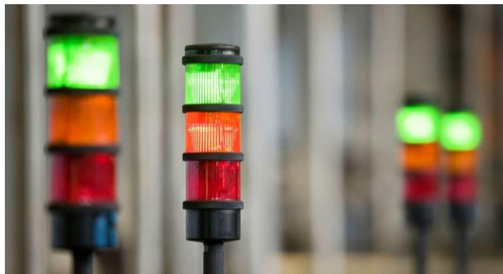
Figura 7 - Exemplo de dispositivo Andon. Retirado de EngProcess (2017).
