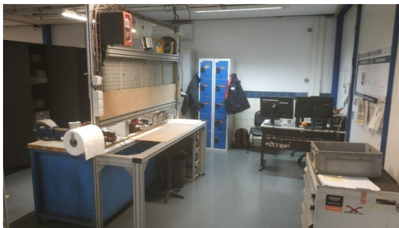
Figura 58 - Construção de uma nova bancada de trabalho, dedicada à manutenção/reparação de aparafusadoras.
