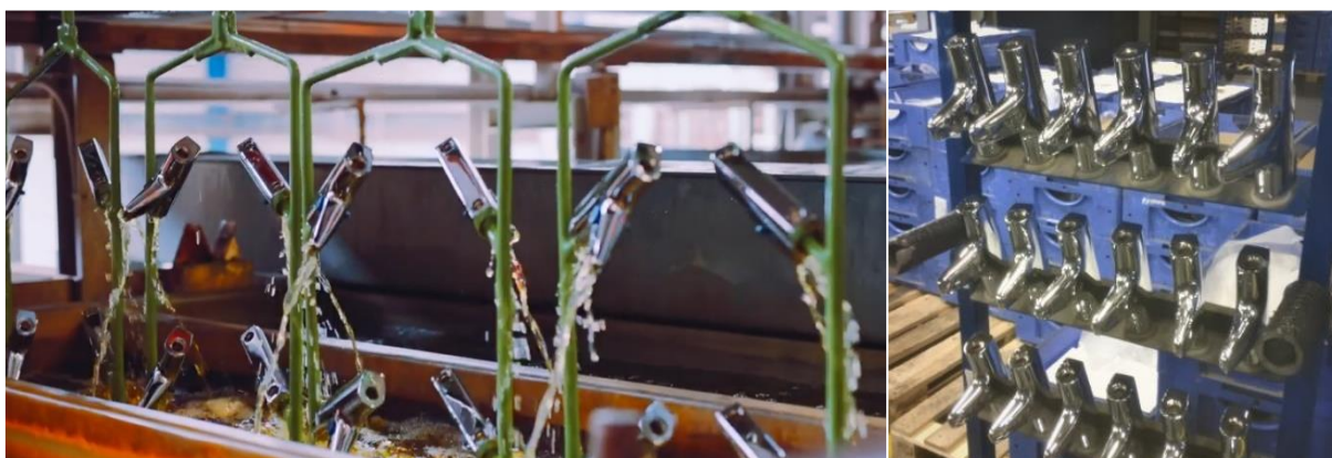
Figura 28 - Banho químico de crómio (à esquerda); corpos cromados (à direita).
