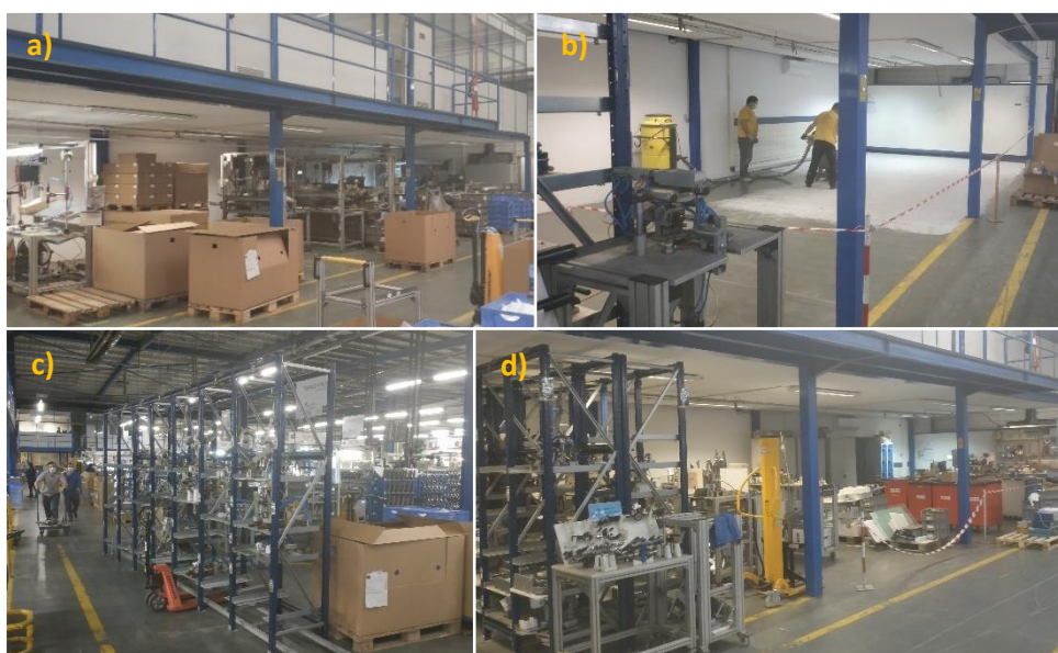
Figura 55 - Fases da realocação da Ferramentaria da Montagem: a) espaço inicial; b) pavimentação; c) transporte de equipamentos; d) novo espaço da Ferramentaria da Montagem.
