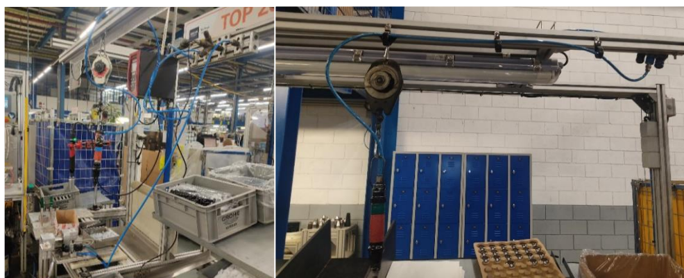
Figura 67 - Organização dos tubos de ar comprimido, de ligação às aparafusadoras: antes (à esquerda) e depois (à direita).
