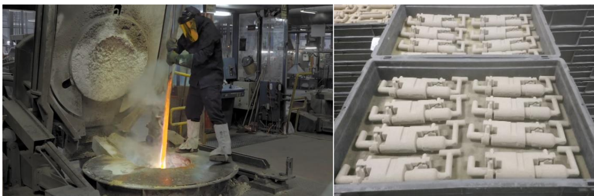
Figura 22 - Forno da fusão central (à esquerda); Caixas de machos (à direita).
