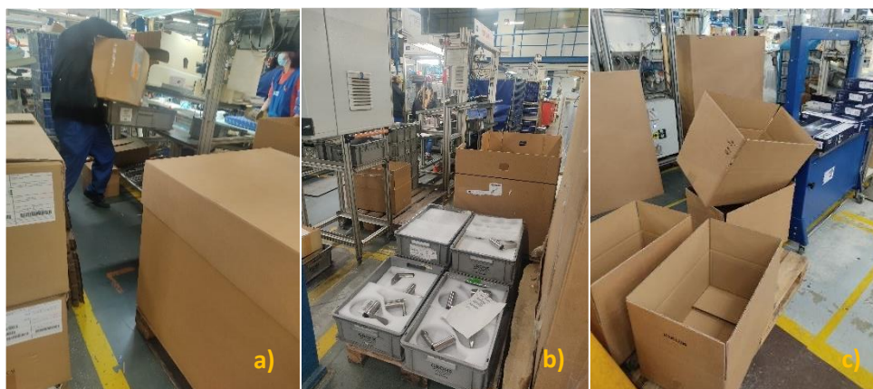
Figura 61 - Estado inicial das linhas de montagem: a) corredores estreitos; b) material nos corredores; c) falta de espaço para a realização de todas as operações.
