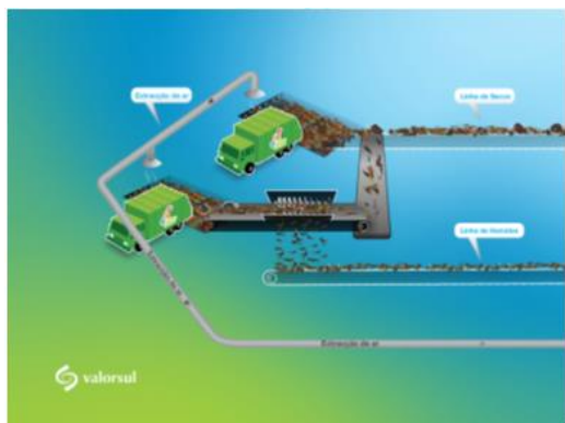
Figura 12 - Recepção de resíduos orgânicos
