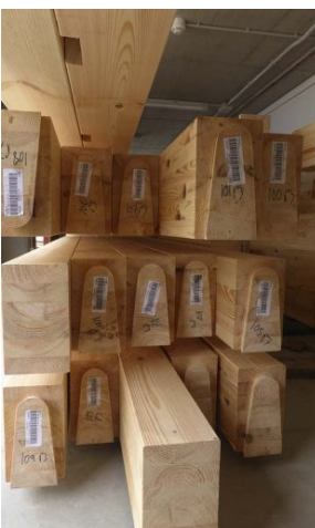
Fig. 154. Sistema estructural a base de madera laminada con ensamble de cola de milano.
