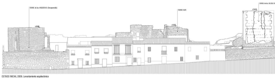
Fig. 33. Levantamiento arquitectónico de alzado Sur. Estado inicial. 2009
