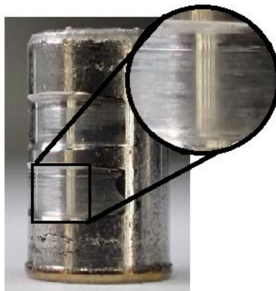
Figura 24 - Exemplo de desgaste por abrasão num pino
