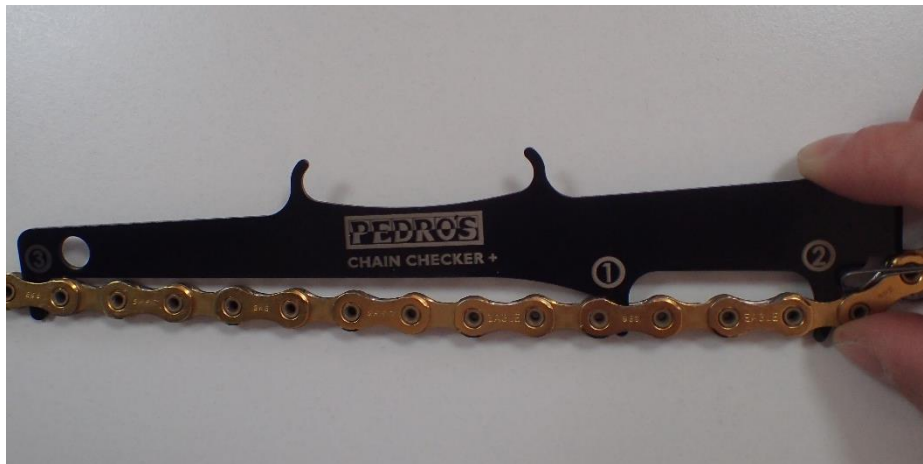
Figura 29 - Ferramenta indicadora de desgaste recomendada pela SRAM
