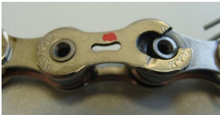
Figura 15 - Corrente com placa exterior partida
