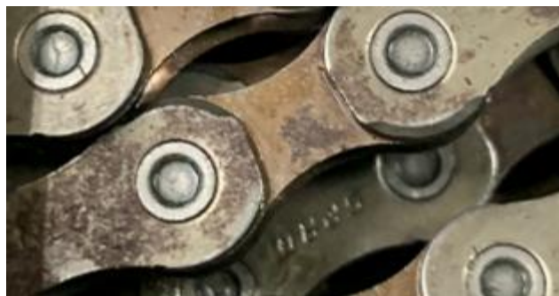
Figura 18 - Corrente com alguma corrosão nas placas
