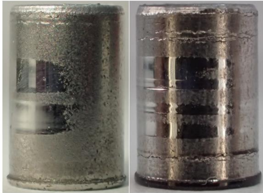
Figura 37 - Comparação de pino de corrente utilizada em Estrada vs. BTT respetivamente
