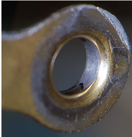
Figura 43 – Furo de placa interior de corrente FHC com 0,83% de alongamento
