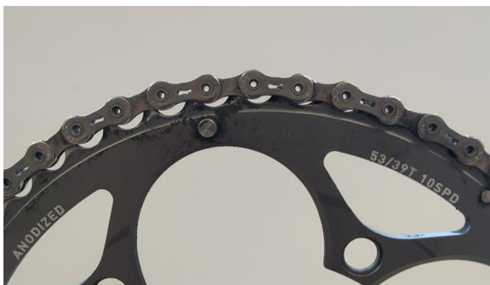
Figura 27 - Mau engrenamento de corrente muito desgastada devido ao passo alongado
