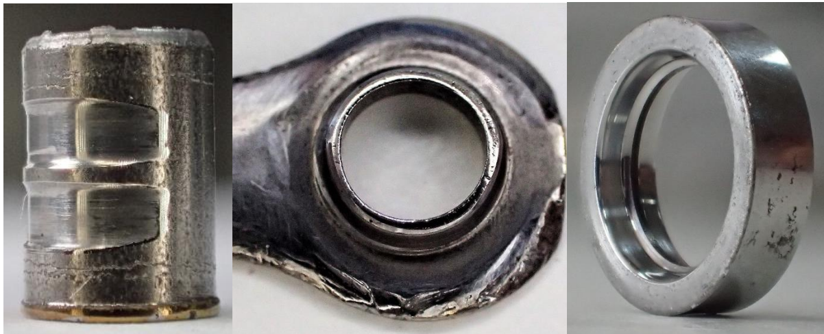
Figura 13 - Componentes com desgaste, pino, placa interior e rolo por ordem
