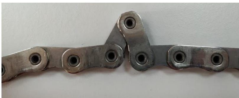
Figura 16 - Corrente com pontos duros
