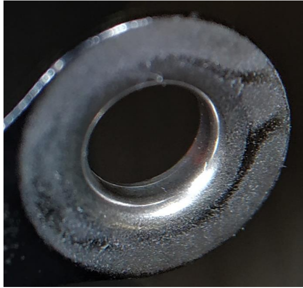
Figura 44 - Furo de placa interior de corrente FHC com 0,09% de alongamento
