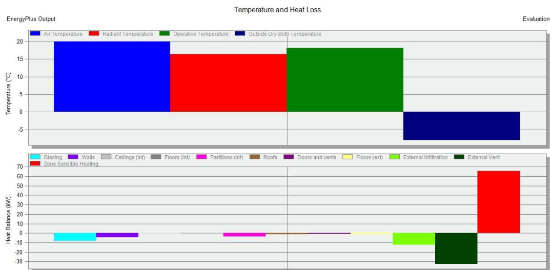
Figura 7: Representação gráfica das perdas de calor e temperatura, e necessidade de aquecimento total da instalação
