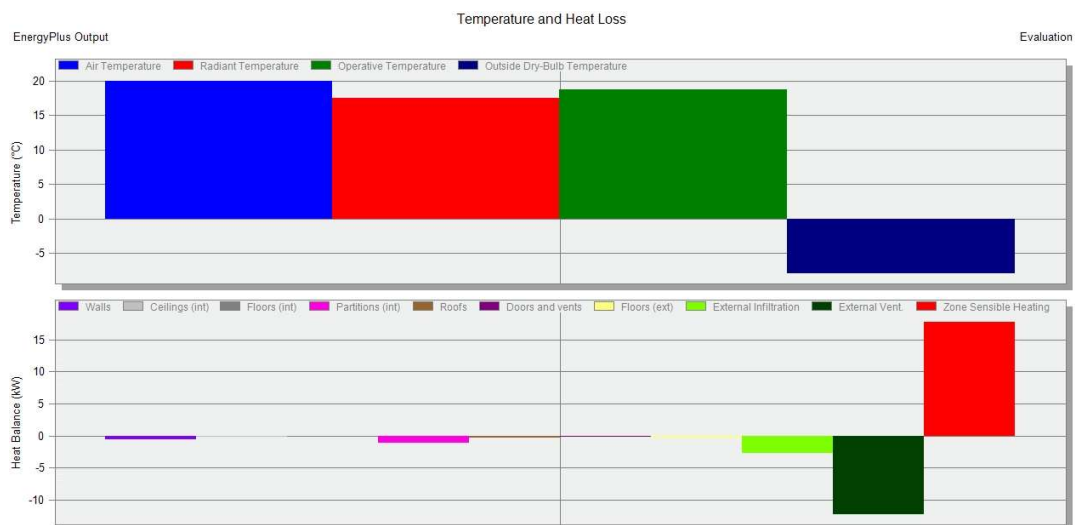
Figura 6: Representação gráfica das perdas de calor, temperaturas e necessidade de aquecimento do piso “A-Deck”
