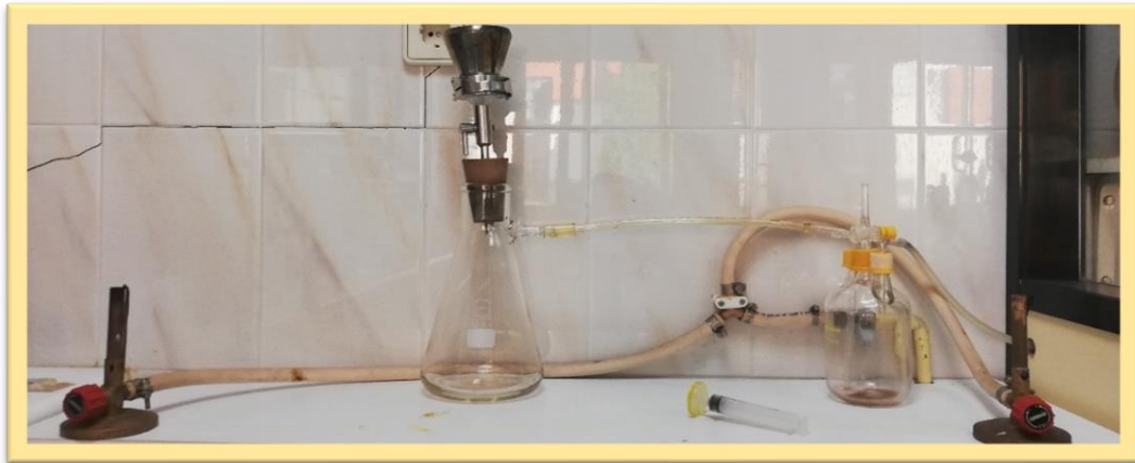
Figura 40 - Equipamento para ensaios de microbiologia (Bicos de Bunsen, kitasato, seringa com filtro e bomba de vácuo)
