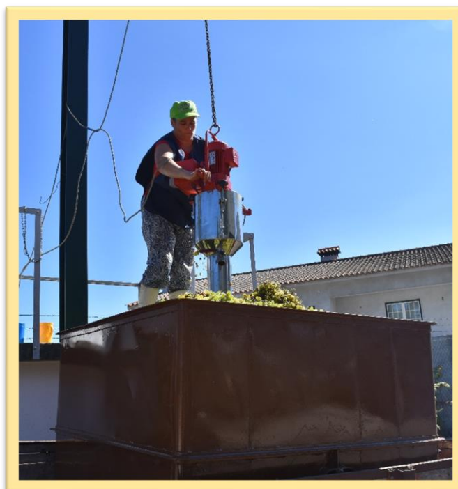
Figura 9 - Recolha de amostra com sonda mecânica
