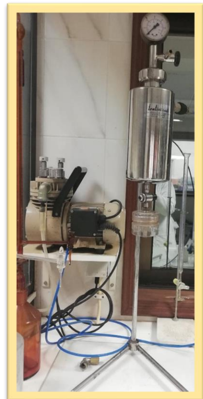
Figura 23 - Aparelho de medição do índice de colmatagem
