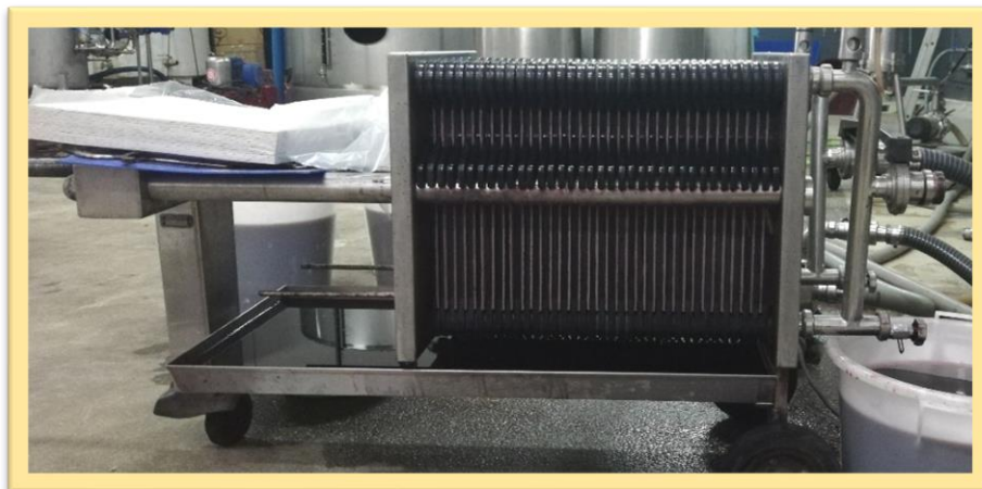
Figura 21 - Filtro de placas
