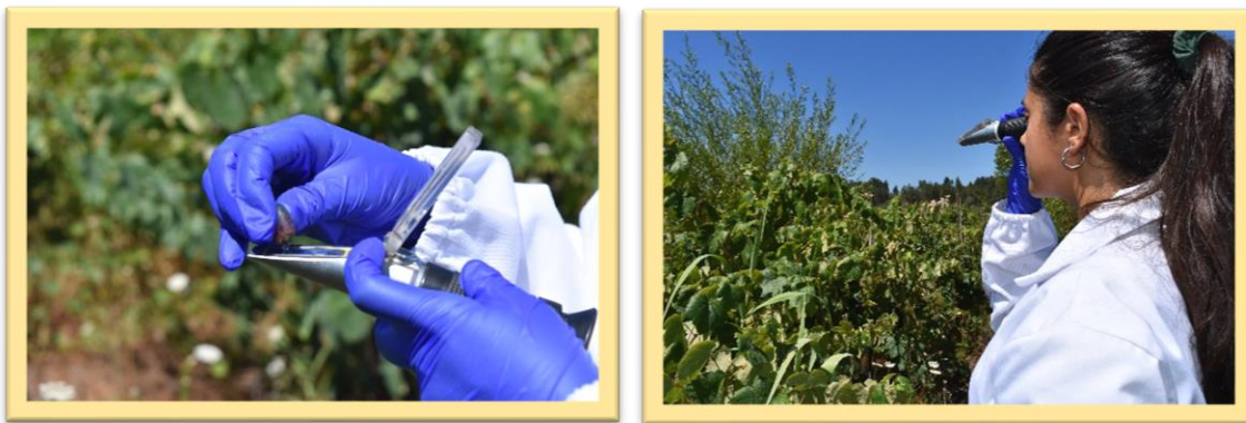
Figura 37 - Determinação do teor alcoólico provável com um refratómetro manual
