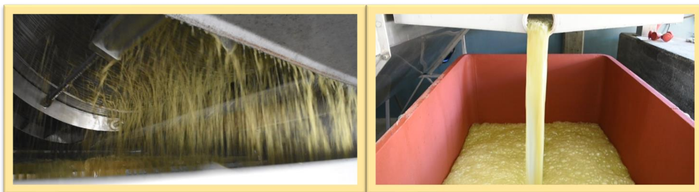
Figura 14 - Escoamento do mosto na prensa
