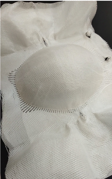
Imagem 16 - Molde da Poleva em processo de termoconformação de TNT. (Fonte: Imagem retirada de vídeo capturado por Tiago Sousa na Poleva)
