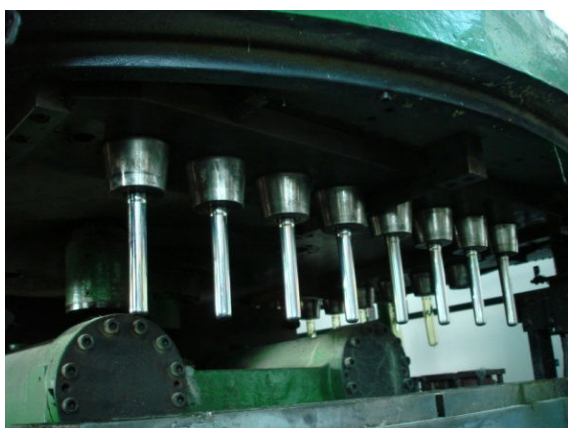
Figura 5. Molde de injeção de pré-formas (Fonte: EspaçoPlás, 2013)
