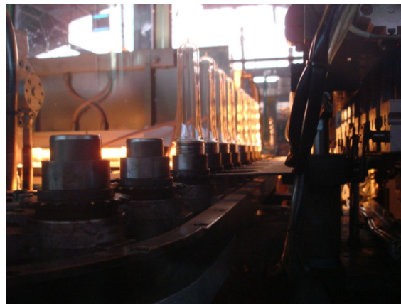
Figura 8. Transferes onde são colocadas as pré-formas de PET (Fonte: EspaçoPlás, 2013)
