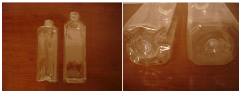
Figura 14. Comparação entre embalagem de PET que deformou por ação do calor e embalagem de PET conforme, com respectiva ampliação das bases (Fonte: EspaçoPlás, 2013)
