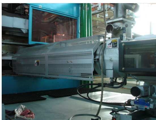
Figura 4. Fuso de máquina de produção de embalagens em PET (Fonte: EspaçoPlás, 2013)
