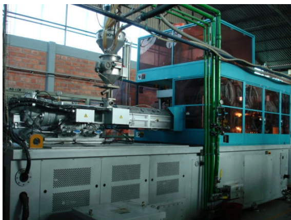
Figura 2. Máquina de Injeção - Sopros, para produção de embalagens em PET (Fonte: EspaçoPlás, 2013)
