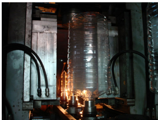
Figura 11. Saída de embalagem em PET do molde de sopro (Fonte: EspaçoPlás, 2013)
