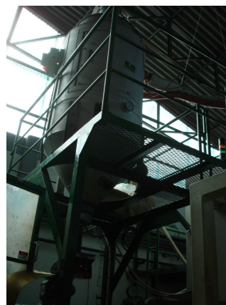
Figura 3. Estufa de secagem do material PET (Fonte: EspaçoPlás, 2013)
