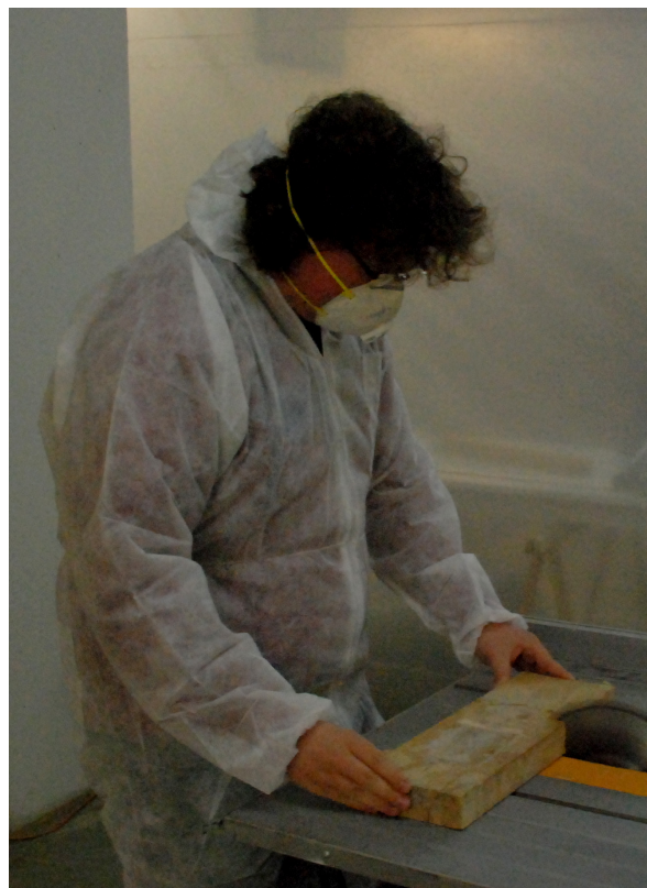
Figura 78. Corte de peças de madeira para modelos.
