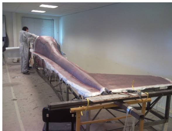
Figura 77. Laminação de molde de meia fuselagem direita.
