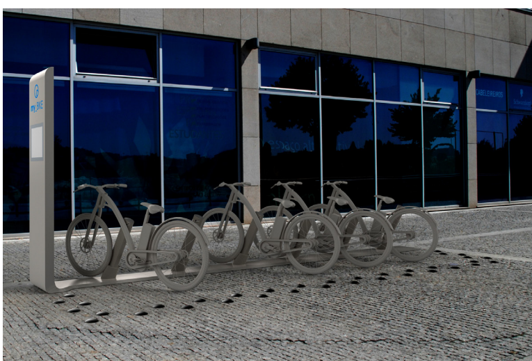
Figura 68. Diferença no solo para evitar que invisuais colidam com o sistema.
