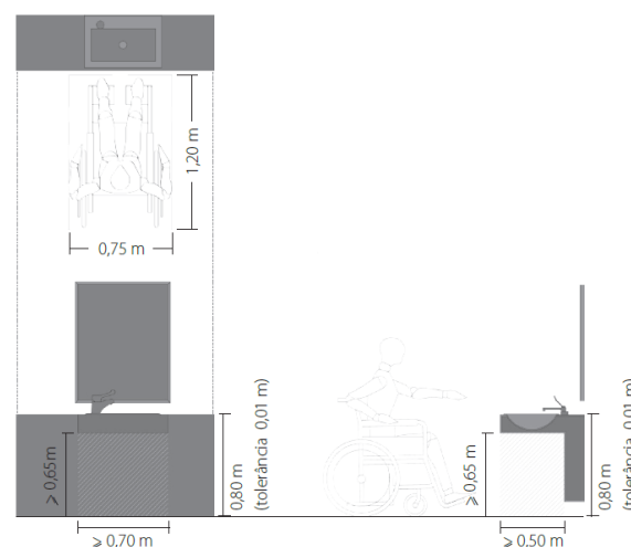
Figura 36 - Condições que devem ter os lavatórios acessíveis.
