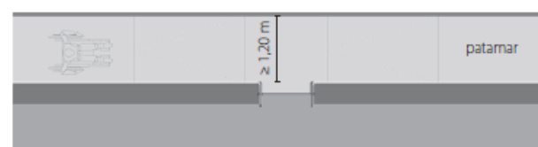
Figura 28 - Patamares, corredores e galerias devem possuir uma largura inferior a 1,2m.
