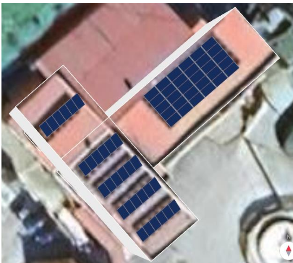
Figura 5.10 - Posicionamento dos módulos fotovoltaicos (SmartDesign 2.0, 2026).
