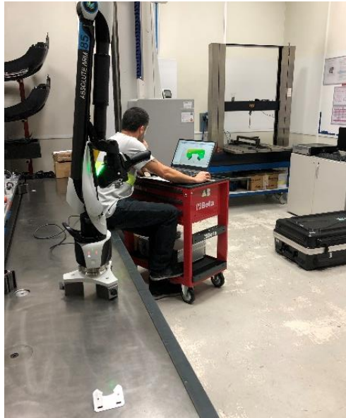
Figura 107 - Equipamento CT utilizado para medição do componente estampado.
