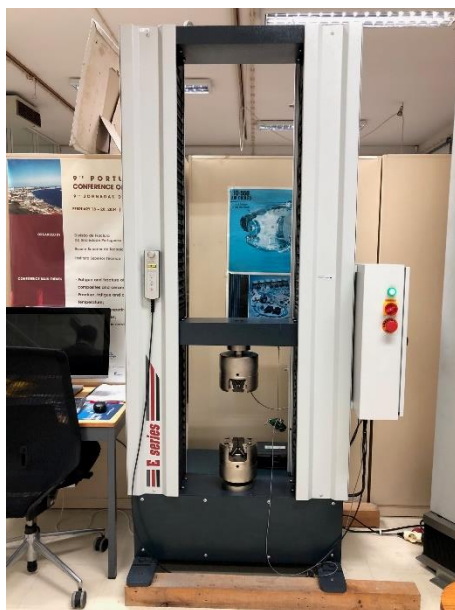
Figura 34 - Máquina de teste de tensão utilizada para ensaio mecânico ao AA2024.
