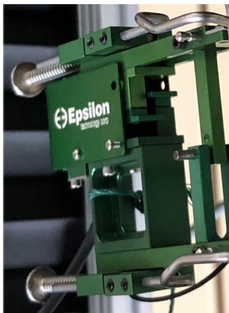
Figura 35 - Extensómetro utilizado no teste de tração.
