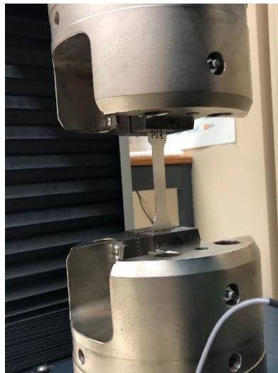
Figura 40 - Provete colocado máquina de ensaios de tração.
