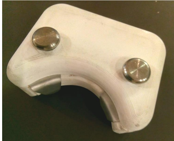
Figura 105 - Ferramenta e peça estampada após processo de estampagem.
