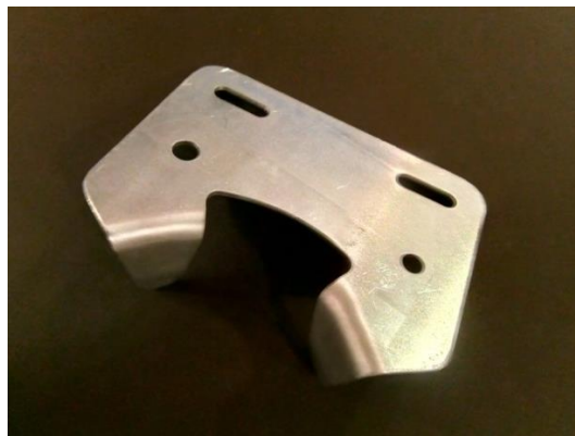
Figura 106 - Peça amostra produzida por estampagem através do processo rubber forming .
