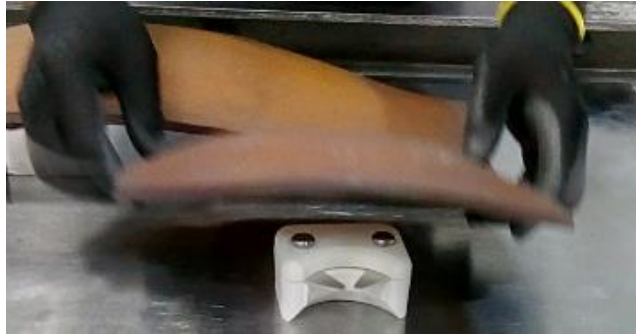
Figura 104 - Posicionamento da ferramenta na prensa.
