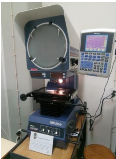
Figura 92 - Projetor de perfis MITUTOYO presente na sala de medição da ESTS.
