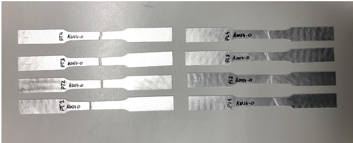
Figura 44 - Provetes após teste tração material A2024-O.
