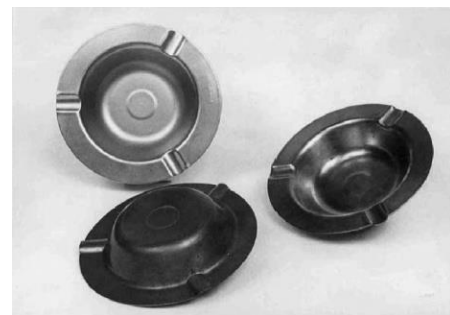
Figura 20 - Exemplo de produto produzido em rubber forming .
