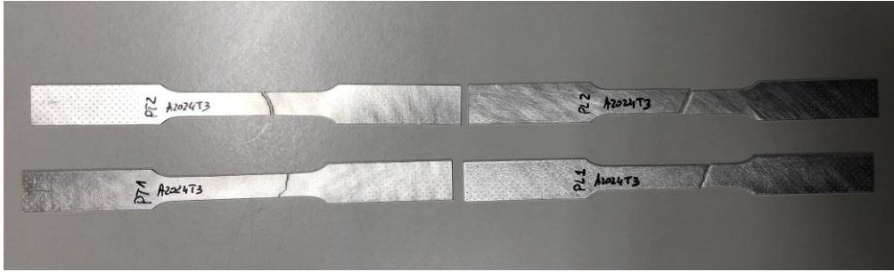
Figura 42 - Provetes após teste tração material A2024-T3.
