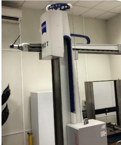
Figura 95 - Equipamento CMM utilizado para medição da Matriz.
