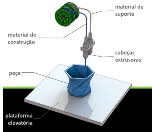
Figura 49 - Ilustração do processo FDM®.
