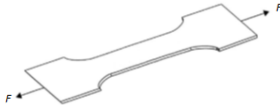
Figura 11 - Representação de provete típico para ensaio de tensão uniaxial.
