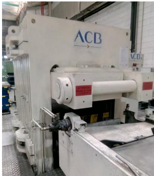
Figura 103 - Prensa por processo rubber forming utilizada para ensaio pratico.
