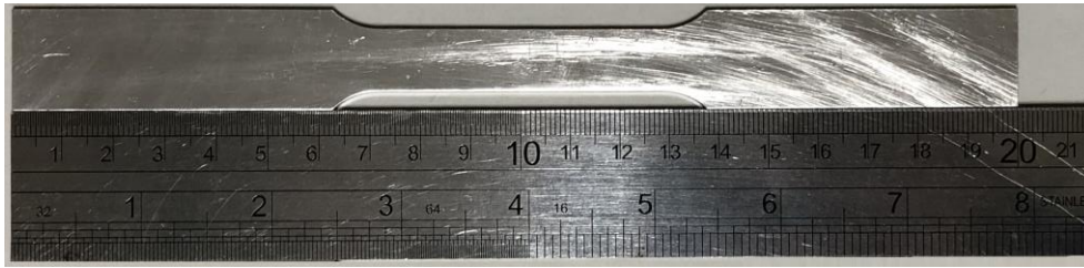
Figura 38 - Análise da dimensão real do provete AA2024 antes do teste de tração.
