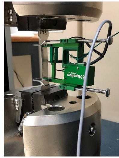
Figura 41 - Colocação do extensómetro sobre o provete a testar.
