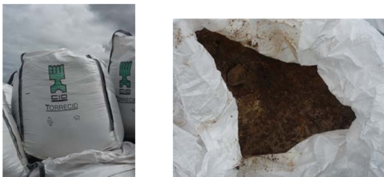
Figura 3.16 – Big bag tipo utilizado (esquerda) e constituição do mesmo (direita).
