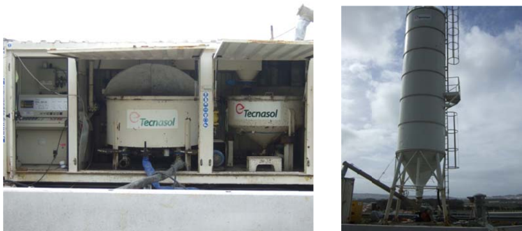
Figura 3.30 – Central de mistura METAX MIX JM-30 (esquerda) e silo para armazenamento de cimento (direita).
