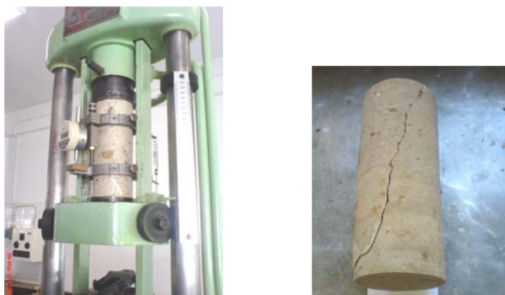
Figura 3.36 - Ensaio de compressão uniaxial (esquerda) e zona de rotura (direita), num provete da coluna 76.
