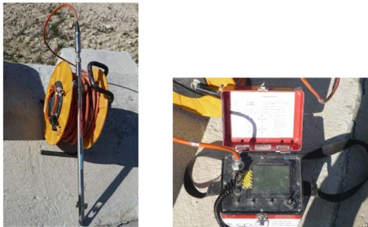
Figura 4.12 – Torpedo e cabo eléctrico (esquerda) e aparelho de medição de deslocamentos (direita).
