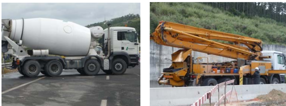
Figura 3.44 – Camião betoneira (esquerda) e auto bomba (direita).
