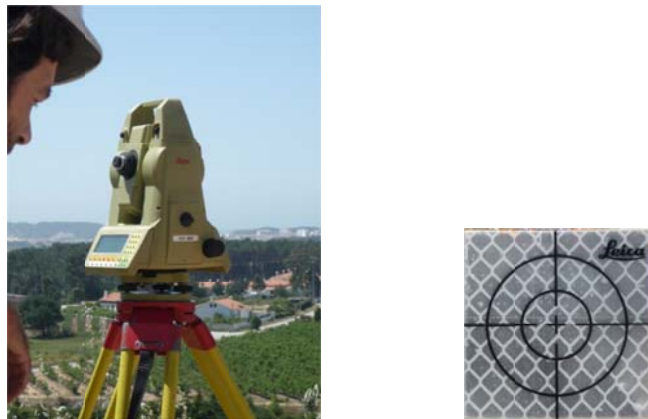
Figura 4.1 – Estação total Leica TCA 1800 e alvo topográfico tipo prisma reflexão total.
