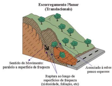
Figura 1.13 – Esquema [12] e imagem [13] de um movimento do tipo escorregamento translacional.
