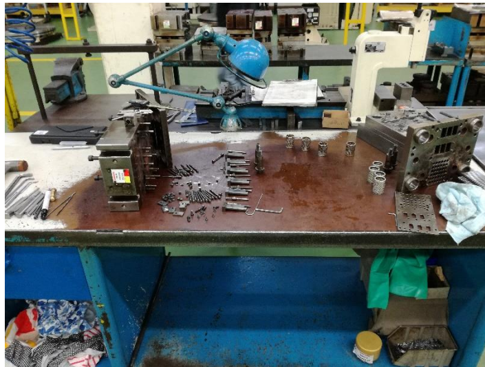
Figura 36. Módulo em reparação na bancada de trabalhos do serralheiro
