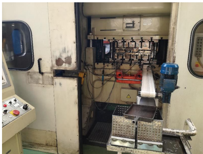
Figura 32. Prensa Minster P2-H100 com uma ferramenta no seu interior
