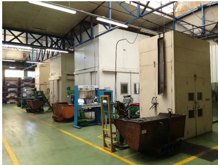
Figura 31. Prensas mecânicas de corte de placas interiores e exteriores
