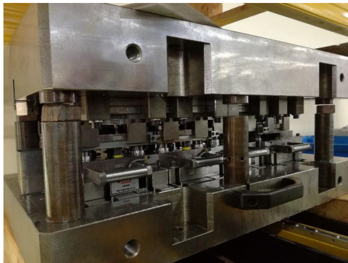
Figura 34. Ferramenta constituída pela sua carcaça e os quatro módulos no seu interior
