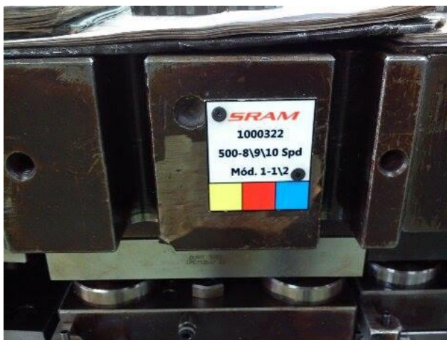
Figura 47. Placa de identificação do primeiro módulo da ferramenta que produz placas interiores de 8, 9 e 10 velocidades
