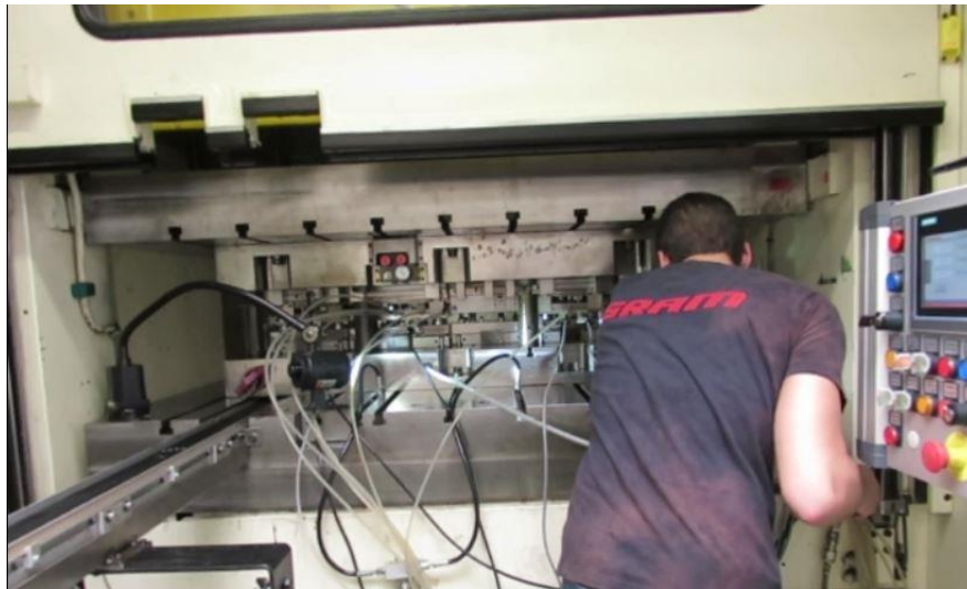
Figura 39. Operador a introduzir a fita de aço na ferramenta
