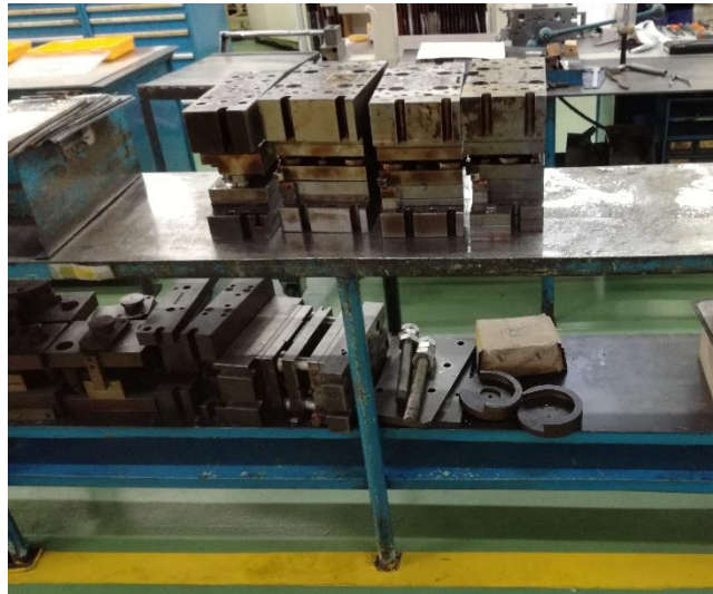
Figura 37. Módulos que aguardam a reparação
