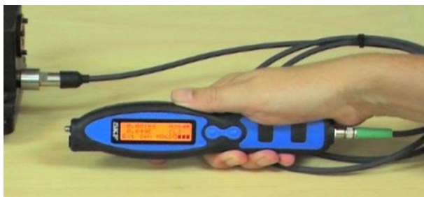
Figura 25 - Uso do sensor externo opcional (Accelera, 2019)
