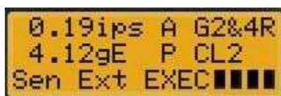
Figura 27 - Indicação de "Sen ext" na tela de medição (Accelera, 2019)
