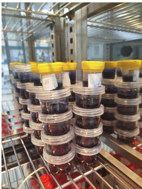
Figura 26 : Colocação das amostras na estufa parâmetrada para ter uma temperatura constante de 37°C, durante 3 dias tem se mantido o nível de corante suficiente de modo a recobrir inteiramente cada espécimen.
