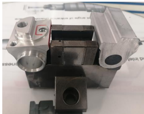
Figura 55 – Exemplos de cilindros maquinados e por maquinar
