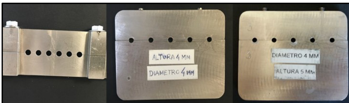
Figura 14 - Moldes metálicos em aço-inoxidável utilizados para o teste de profundidade de polimerização.
