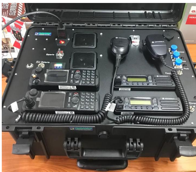
Figura 29 – Equipamento portátil de Comunicações, SIRESP e banda alta VHF (Fonte: @Márcio Teles)
