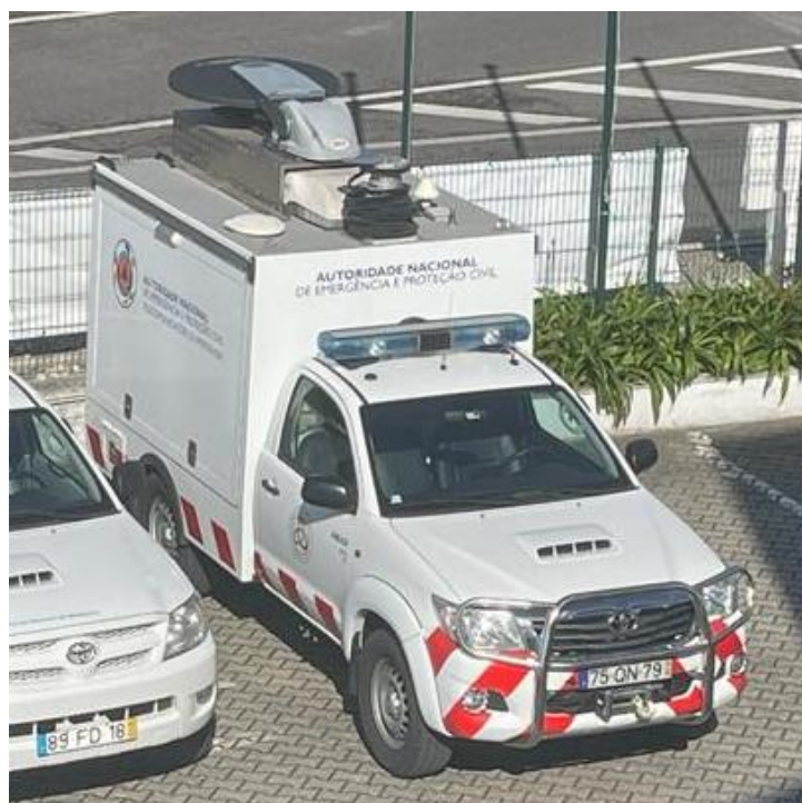
Figura 24 – Estação Móvel SIRESP, ligeira (Fonte: @Márcio Teles)
