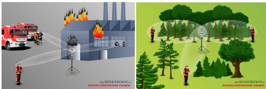
Figura 27 – Uso de acessório para ampliação da função Repeater (Emmerl, n.a.)
