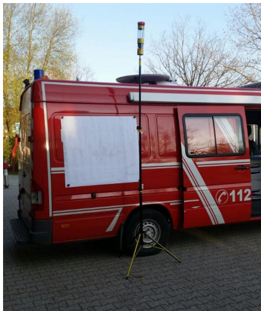
Figura 28 – Suporte para terminal com a função Repeater (feuerwehr-parkstetten, 2016)
