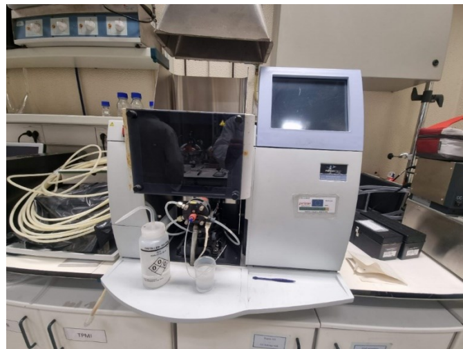
Figure 20 - Atomic Absorption Spectrometer (AAS), @ CERENA - IST
