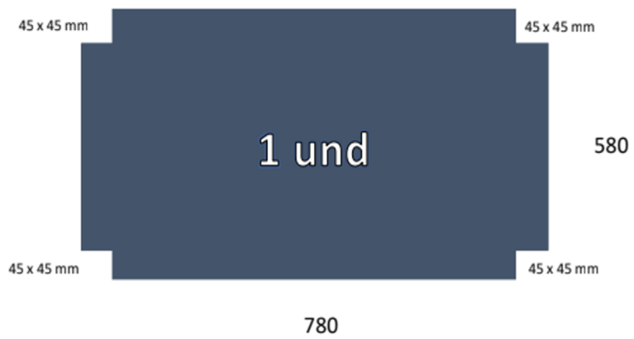
Figura 38: Tamos em MDF com revestimento fenólico
