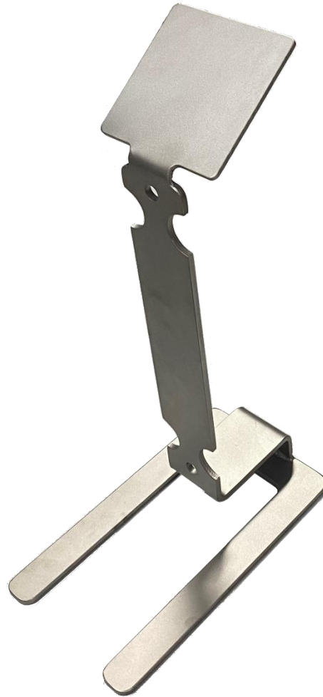
Figura 6.4 – Protótipo do suporte do mini-skid
