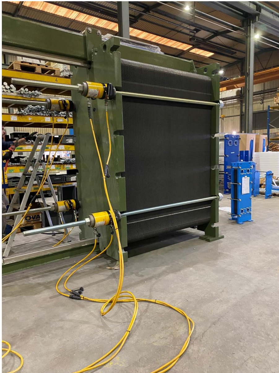
Figura 3.15 - Aperto do permutador com expansores
