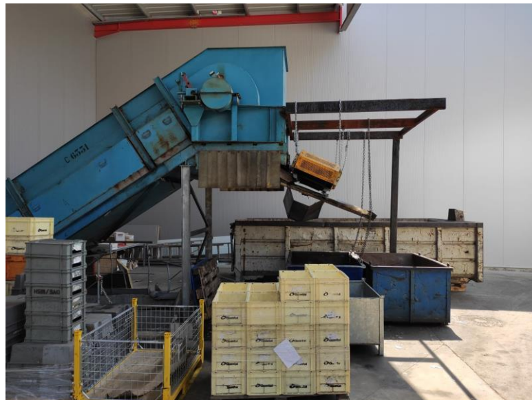
Figura 12 - Estrutura do tapete transportador de sucata
