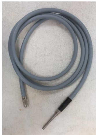
Figura 3- Cabo de fibra ótica que permite a transmissão de luz. Fonte: Autora.
