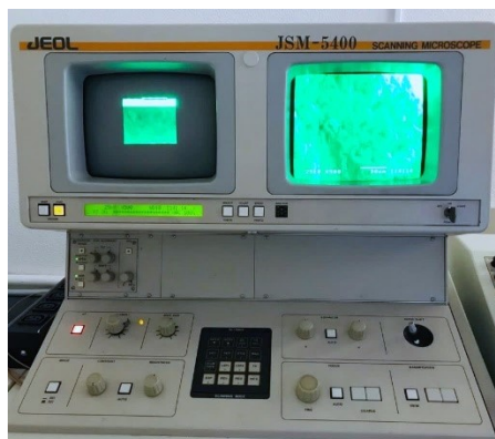
Figura 6 - Microscópio eletrônico de varrimento modelo JOEL JSM-5400.
