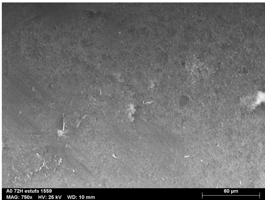
Figura 16 - Imagem obtida em SEM, a uma ampliação de 200x, de uma amostra do mineral do ensaio A0.2. A imagem sugere a existência de uma estrutura tridimensional, pela existência de uma leve granulação.
