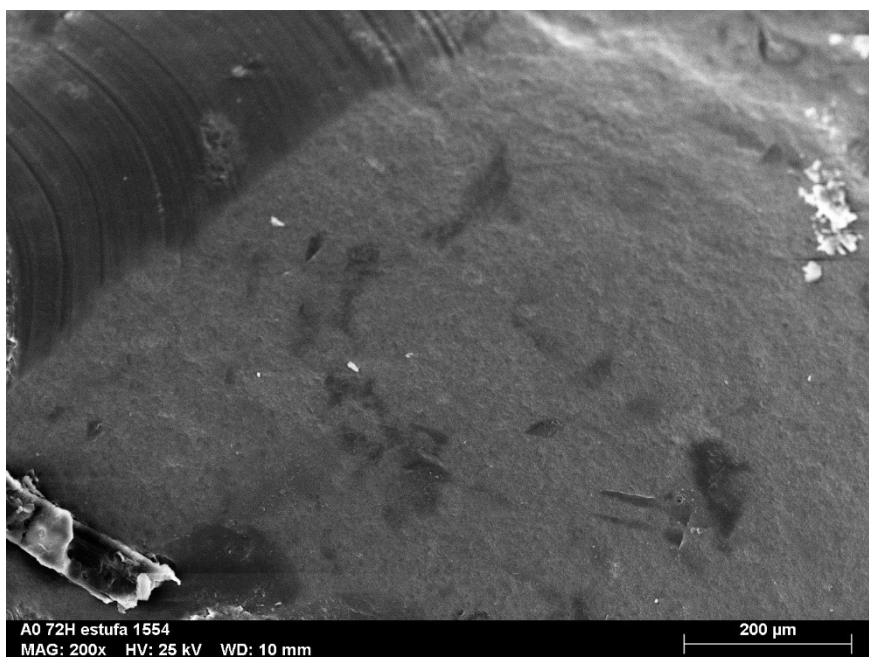
Figura 14 - Imagem obtida em SEM, a uma ampliação de 200x, de uma amostra do mineral do ensaio A0.2. A imagem sugere a existência de uma estrutura tridimensional, pela existência de uma leve granulação.
