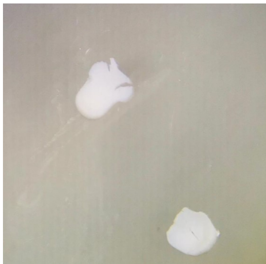
Figura 22 - Imagem de mineral obtida em estereomicroscópio didático Leica EZ4D, onde é possível observar a opacidade homogênea do mesmo. Ampliação 25x.
