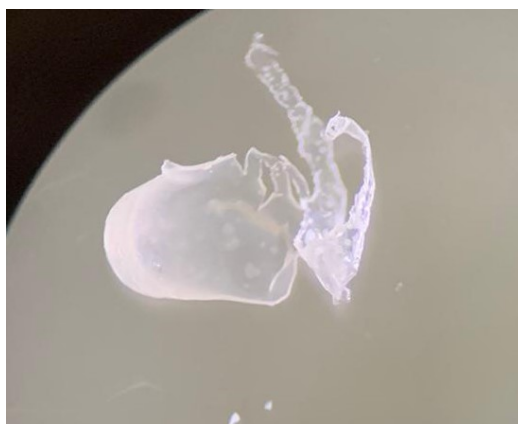
Figura 10 - Imagem de mineral obtida em estereomicroscópio didático Leica EZ4D, onde é possível observar a heterogeneidade do mesmo. Ampliação 25x.
