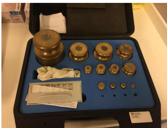
Figura 20 - Massas calibradas para testar balanças pediátricas.
