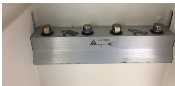
Figura 51 - Vedantes (círculos pretos) para os encaixes dos vaporizadores.
