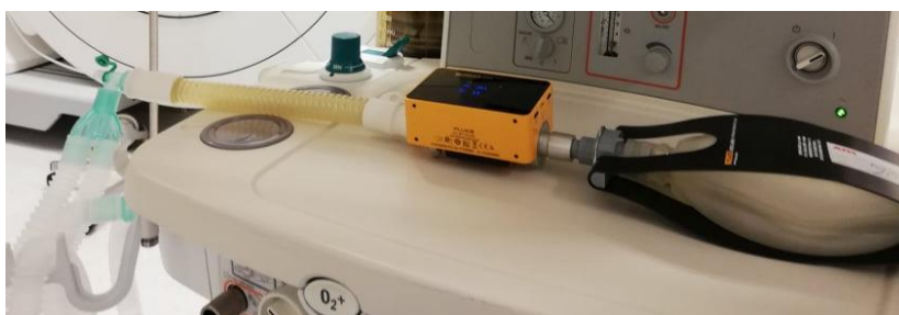
Figura 19 - Analisador de fluxo de gás: Fluke VT305.
