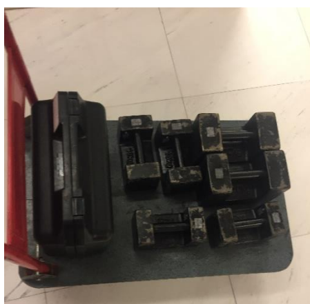
Figura 21 - Massas calibradas para testar balanças para crianças, adolescentes e adultos.
