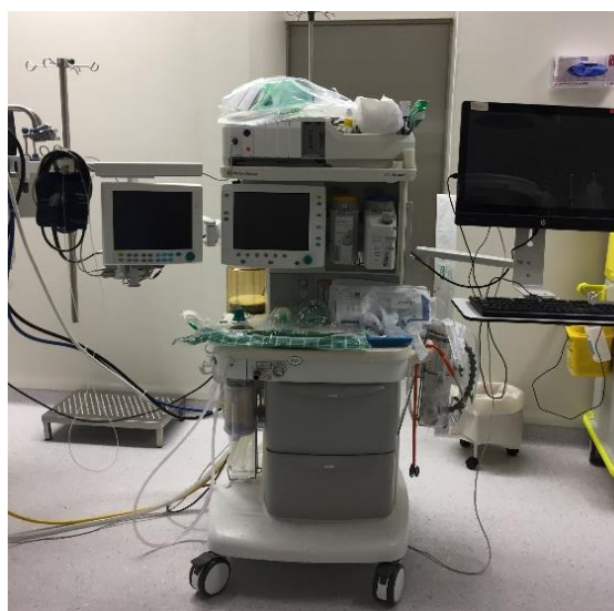
Figura 40 - Exemplo de um ventilador de anestesia, GE S/5 Avance.
