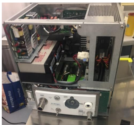
Figura 55 - Baterias do ventilador
