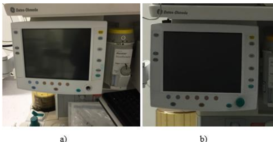
Figura 56 - Substituição do botão do monitor, GE Datex-Ohmeda S/5 Avance.
