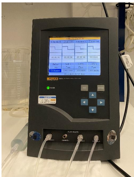
Figura 16 - Analisador de Dispositivos de Perfusão: Fluke Biomedical IDA-5.
