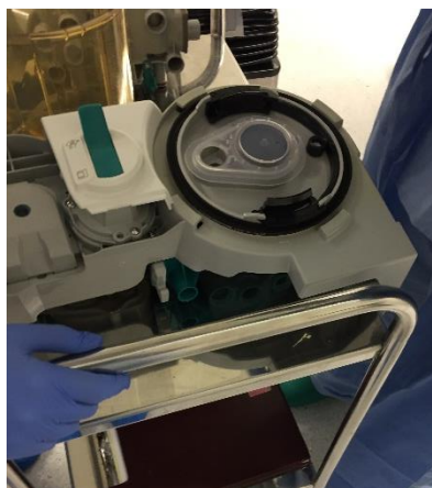
Figura 57 –Recolocação da válvula de libertação de pressão.
