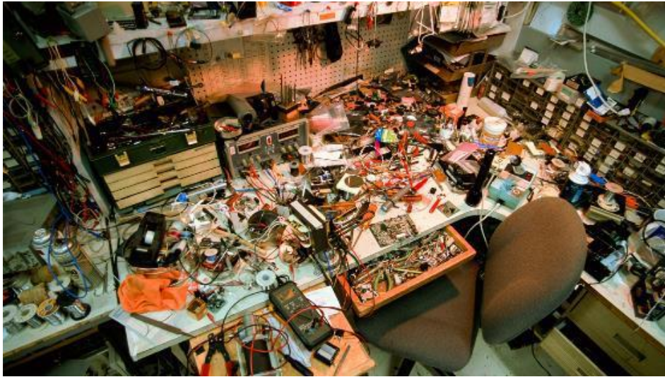
Figura 8 - Local de trabalho onde é necessária a implementação dos 5S (A. Dimitrescu et al. , 2019)
