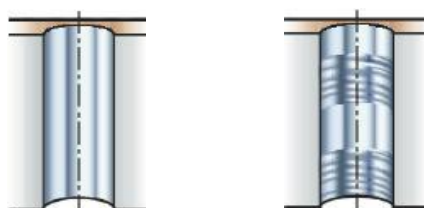
Figura 18. Pobre qualidade superficial acentuada pelo entupimento de aparas (Sandvik, 2015).
