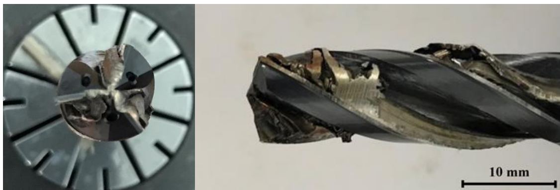
Figura 42. Formação de apara aderente nas arestas de corte, num dos testes com refrigeração externa.
