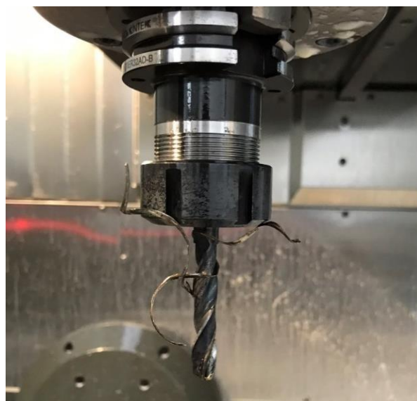
Figura 61. Enrolamento de aparas à volta da ferramenta.
