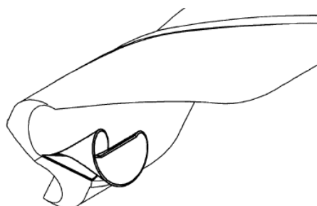
Figura 24. Formação da aparas helicoidais junto à zona de corte (Batzer, et al., 1998).
