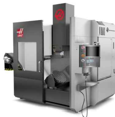
Figura 27. Centro de maquinagem Haas UMC-750SS, utilizado nos testes (Haas, 2020).
