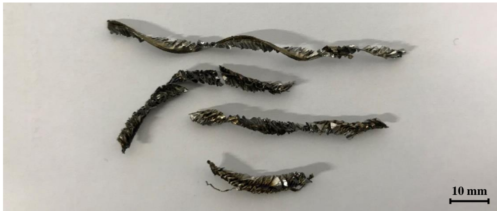
Figura 58. Formação de aparas irregulares na fase final de vida da broca, no furo 30 do teste C3.
