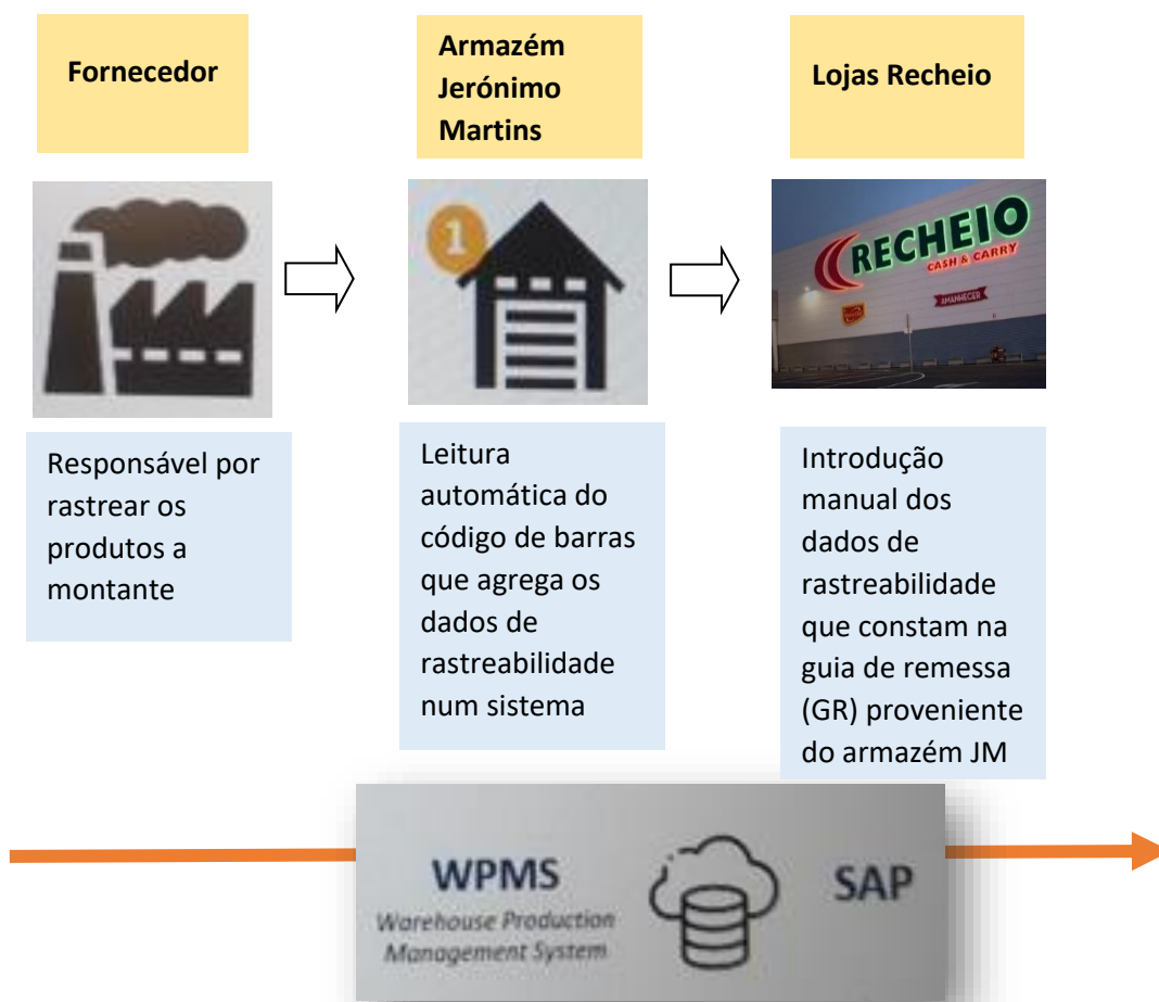
Figura 10 - Fluxo de rastreabilidade no Recheio
