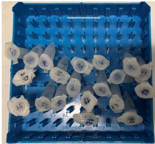
Figura 14: Tubos “eppendorf” contendo o produto final da extração de DNA, fechados com Parafilm®M.
