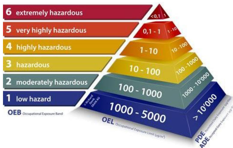
Figura 3 - Pirâmide de classificação de containment , que compara o limite de exposição ocupacional (OEL), a banda de exposição ocupacional (OEB), a exposição diária permitida (PDE) e a exposição diária aceitável (ADE) [10].
