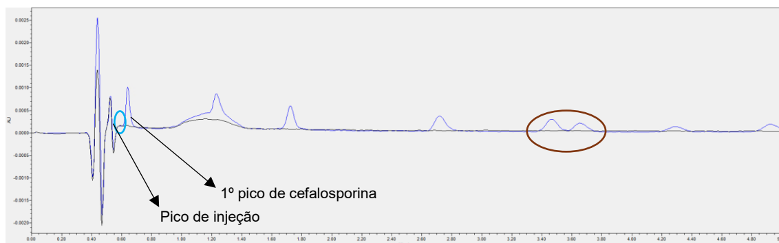
Figura 26 – Cromatograma STD 0,02ppm (azul) vs solvente (preto) com fase móvel 85,5:10:4,5 (tampão fosfato:metanol:acetonitrilo).
