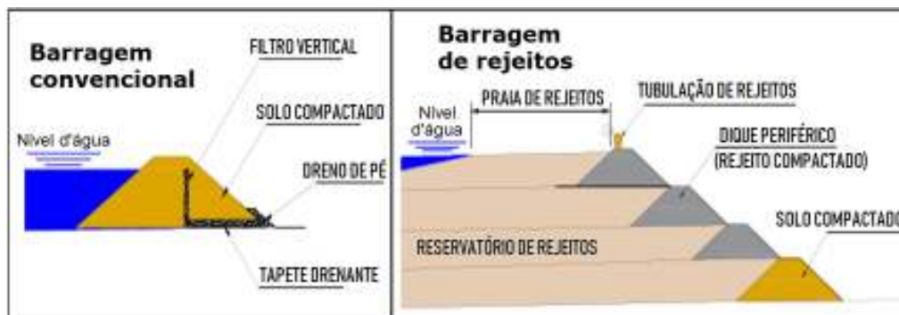
Figura 1 - Esquema de uma Barragem Convencional e de uma Barragem de Rejeito.
