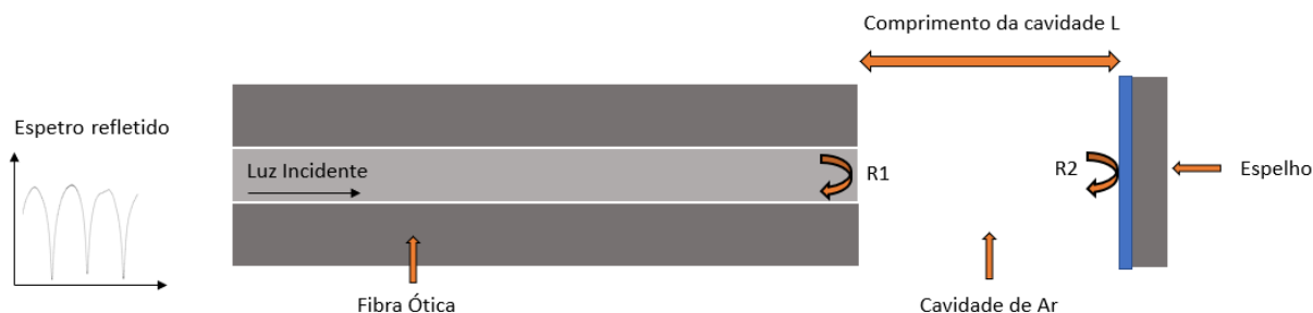
Figura 3.1 - Esquema de um interferómetro Fabry-Pérot em fibra ótica.
