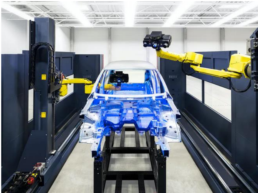
Figura 12 - Aparelho de medição ótica GOM ATOS ScanBox Series 8 [7]
