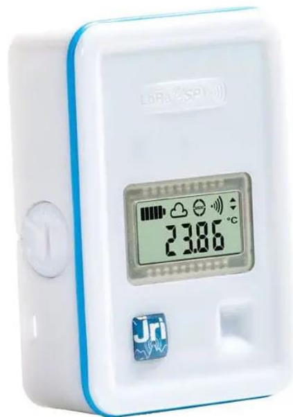
Figura 19 - Dispositivo LoRa para registo de Temperatura e Humidade Online [14]
