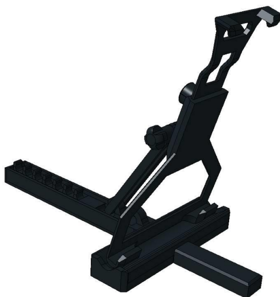
Figura 37 - Modelo CAD do suporte do Tablet
